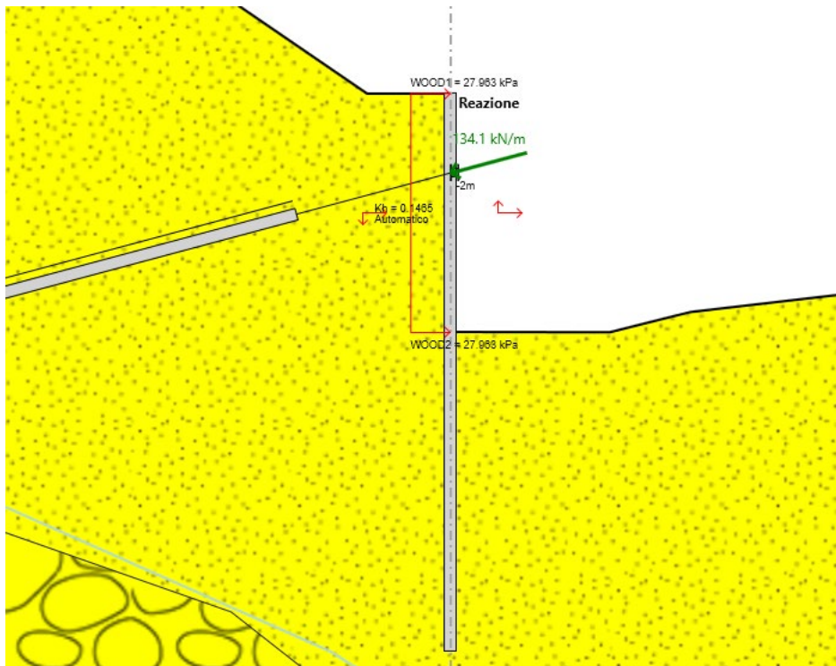
Figura 8.10 Reazioni ai supporti ENV SLU-SISMA
