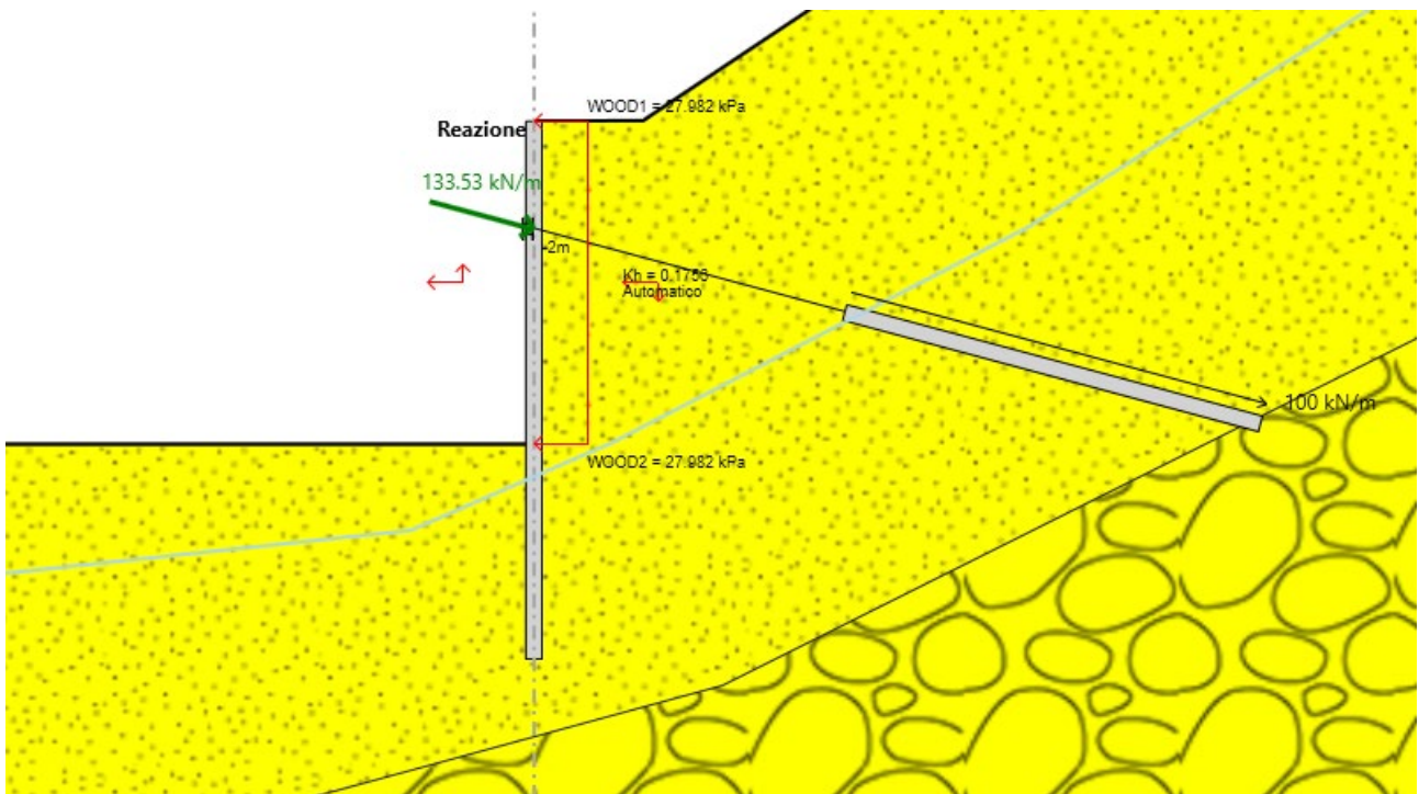
Figura 8.10 Reazioni ai supporti ENV SLU-SISMA
