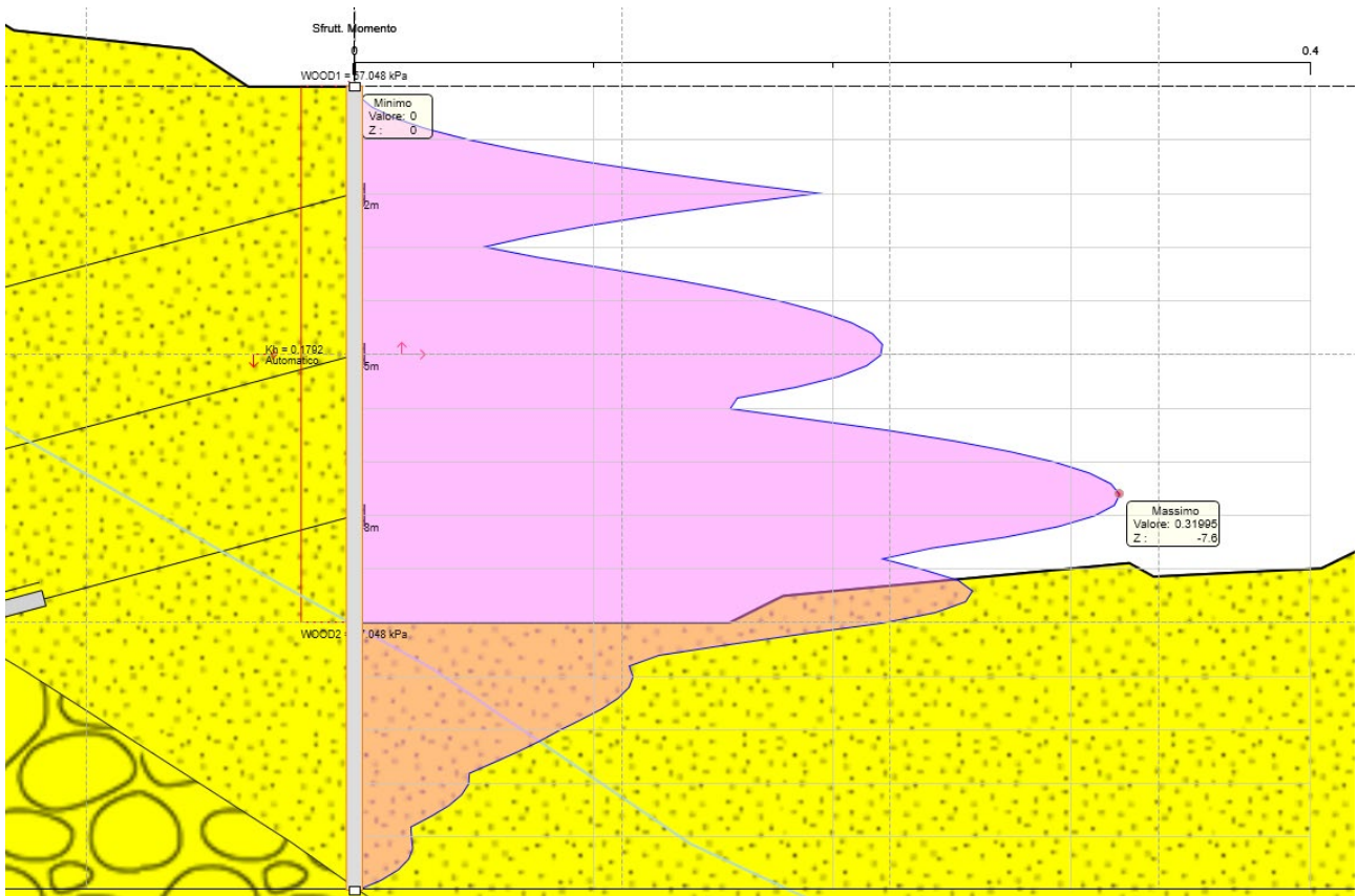
Figura 8.10 Sfruttamento a momento ENV SLU-SISMA
