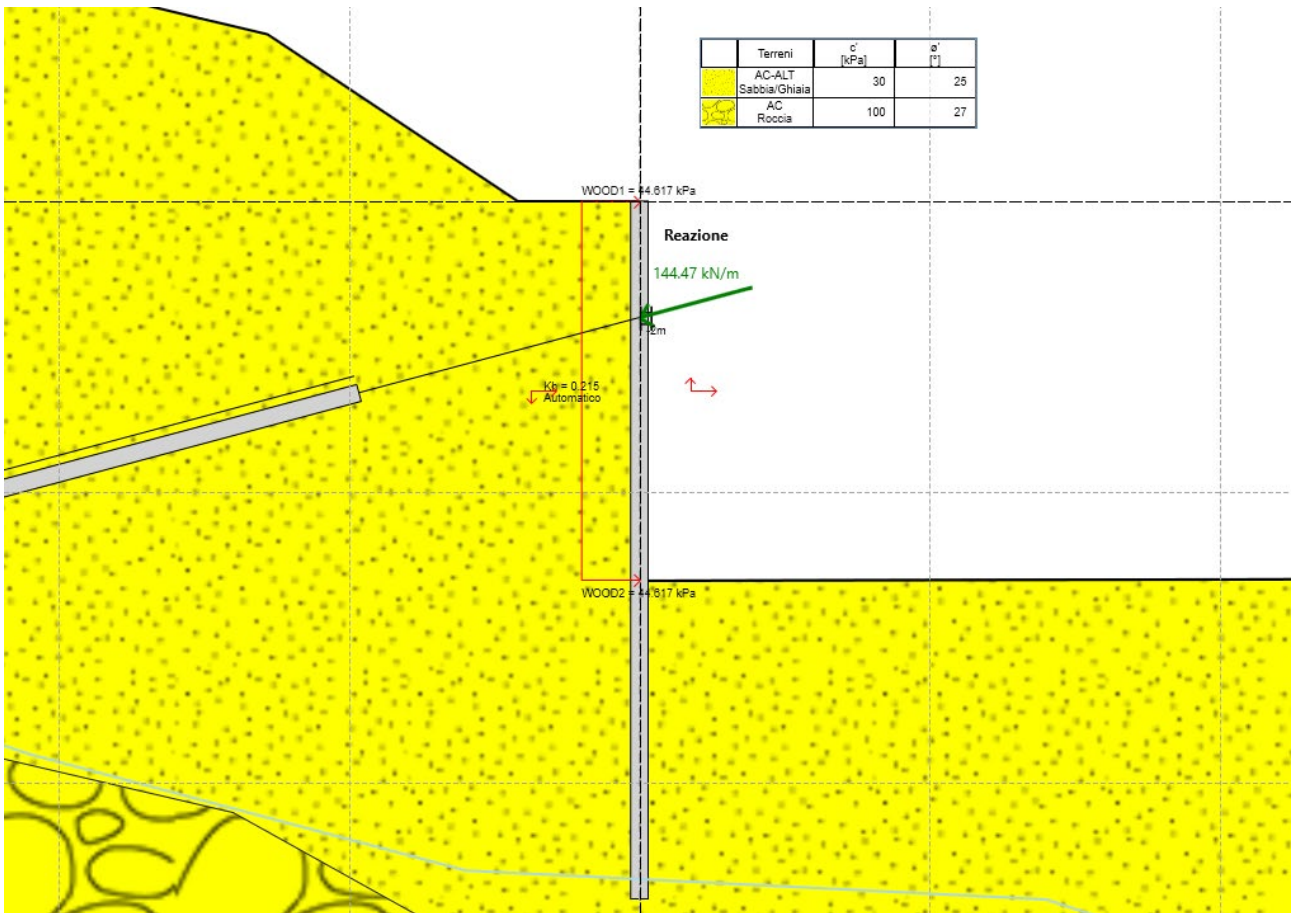
Figura 8.10 Reazioni ai supporti ENV SLU-SISMA
