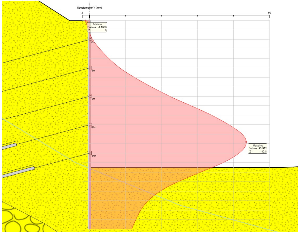
Figura 8.15 Spostamento massimo della paratia
