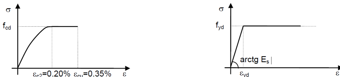
Figura 1-7 Legame costitutivo parabola-rettangolo per il calcestruzzo e legame costitutivo elastico-perfettamente plastico per l'acciaio.
