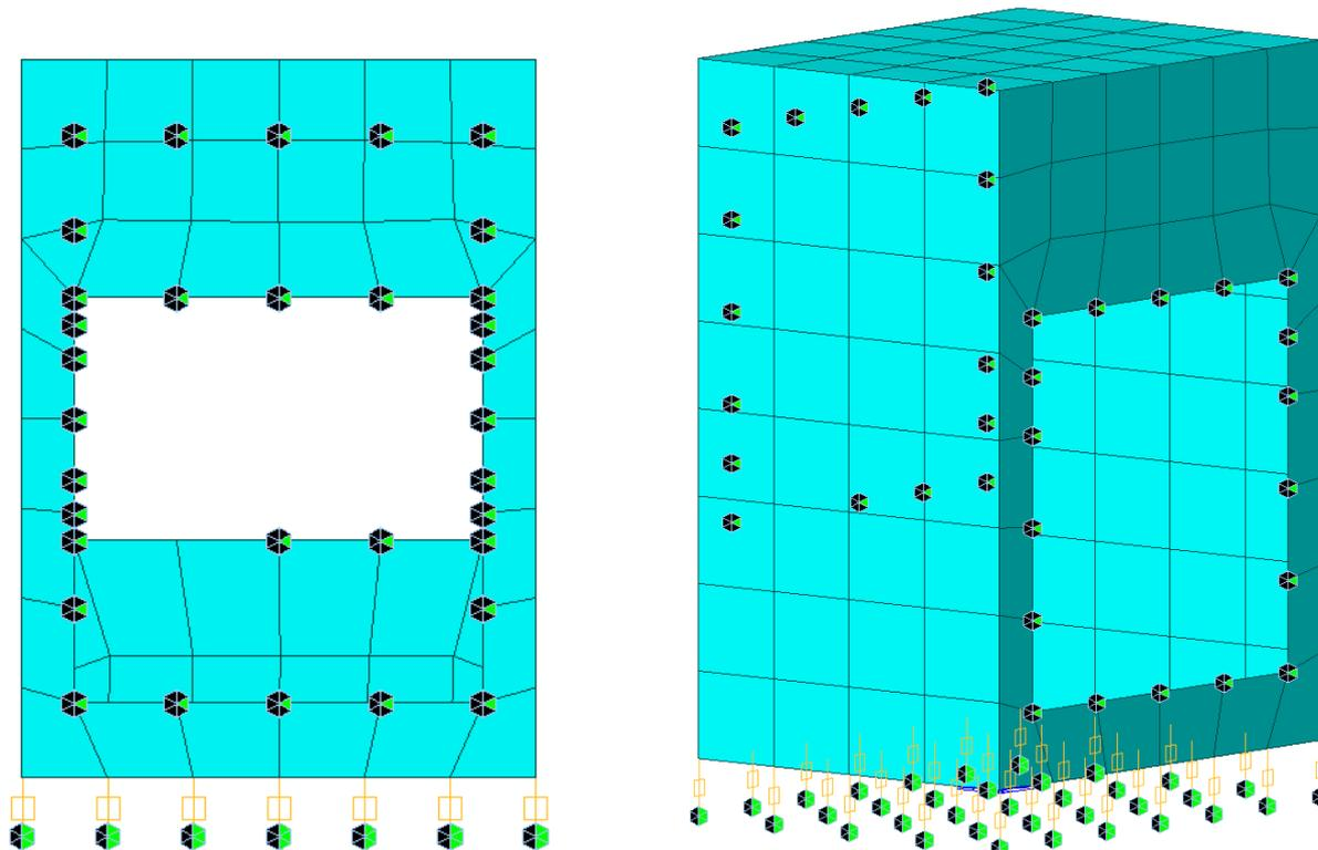
La configurazione peggiore per il pozzetto è quella in cui il pozzetto è vuoto, e subisce lateralmente le spinte del terreno. Per cui sono stati considerati i seguenti contributi di carico:
