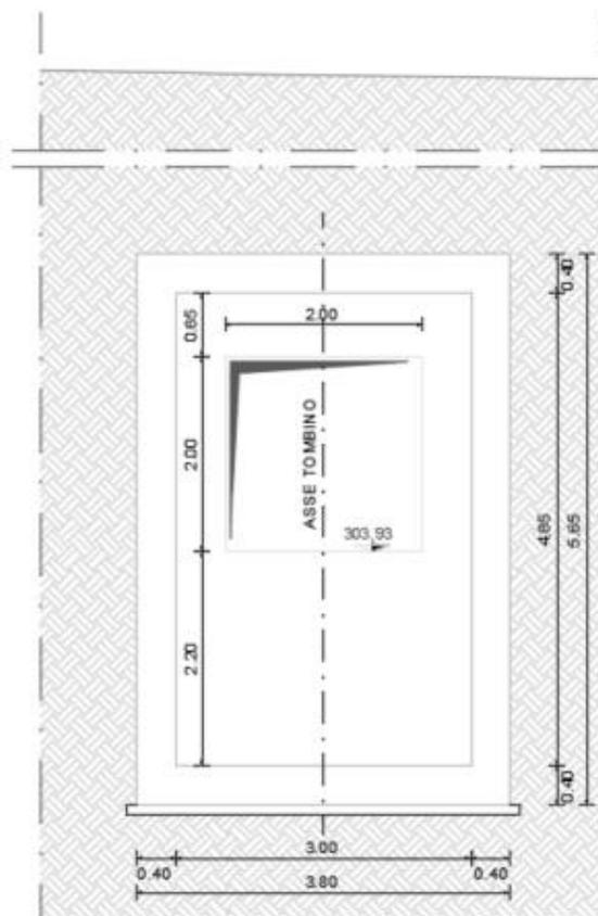
Figura 1 – Sezione trasversale corrente e in corrispondenza dei pozzi
