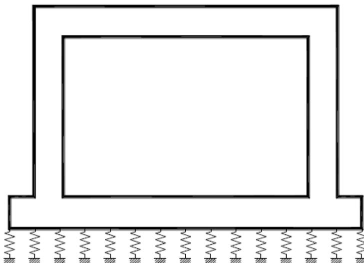
Figura 2 Schematizzazione scatolare
