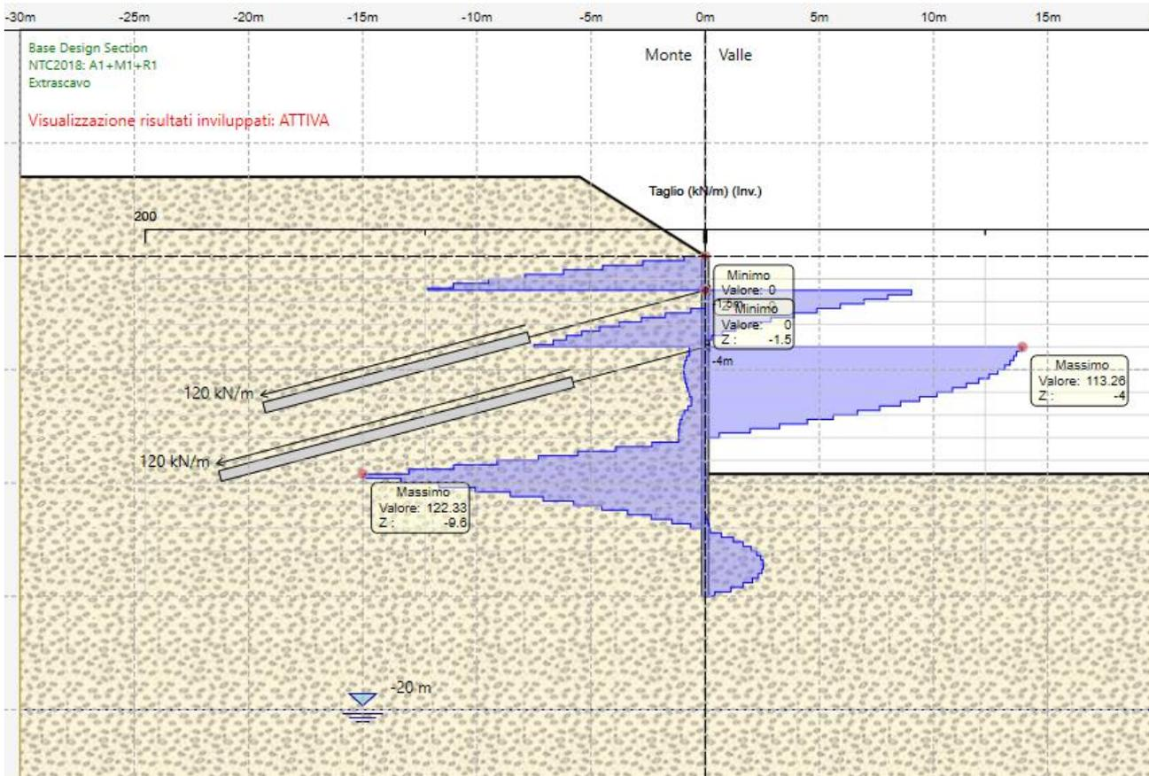
**Figura 16: involuogo dello sforzo di taglio per la combinazione A1+M1+R1 per gli step da 1 a 7 (scavo completato + extrascavo)**
