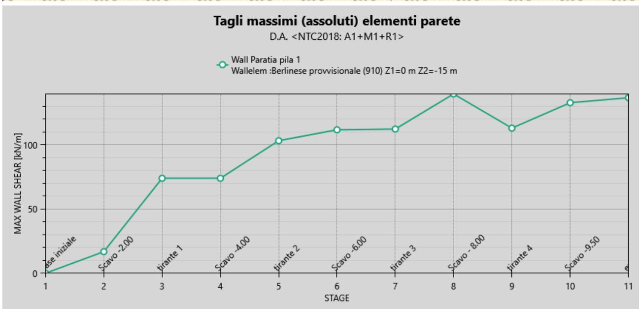
**Figura 22: involuppo dello sforzo di taglio per la combinazione A1+M1+R1 per gli step da 1 a 10 (scavo completato + extrascavo)**
