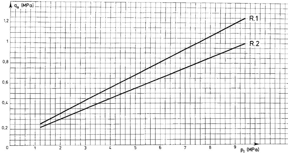
**Figura 3-6 Grafici per il calcolo di  $q_s$  per rocce alterate e fratturate**
