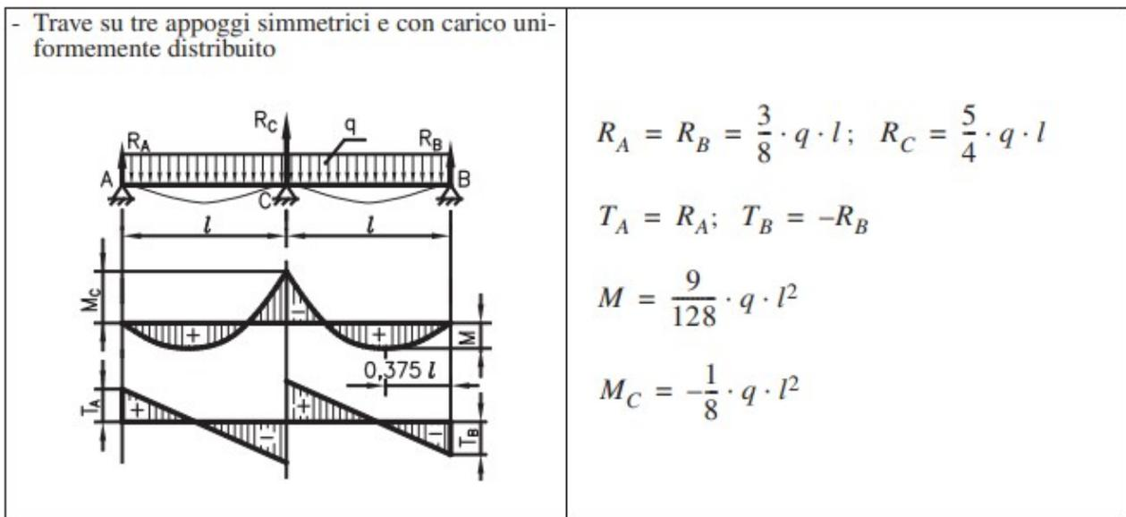
Figura 25: schema statico considerato per lo studio delle travi di ripartizione
