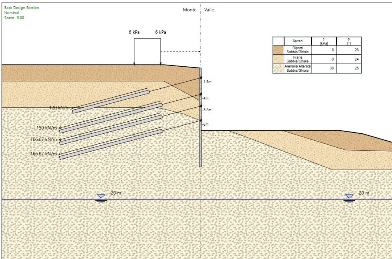
Figura 5 : schema del modello di calcolo adottato
