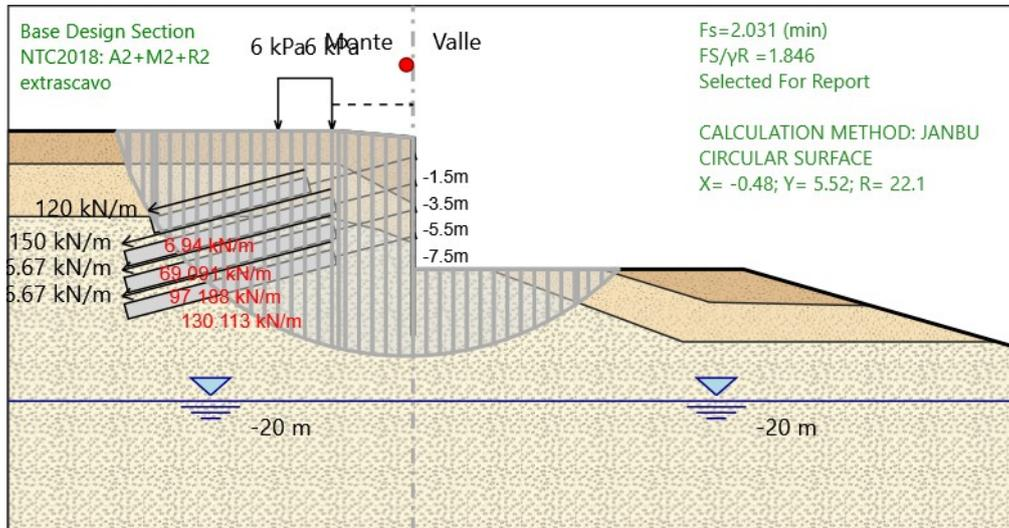
**Grafico Superfici Critiche Analizzate - Design Assumption: NTC2018: A2+M2+R2 - Stage: extrascavo**
