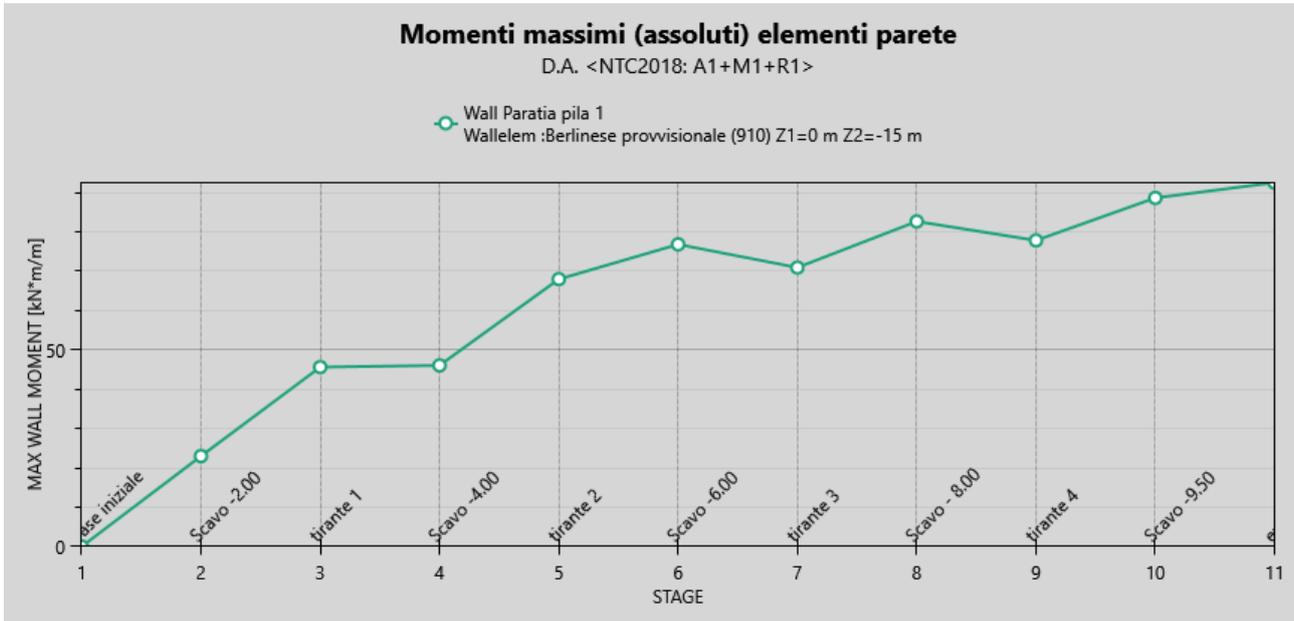
**Figura 21: inviluppo del momento flettente per la combinazione A1+M1+R1 per gli step da 1 a 10 (scavo completato + extrascavo)**
