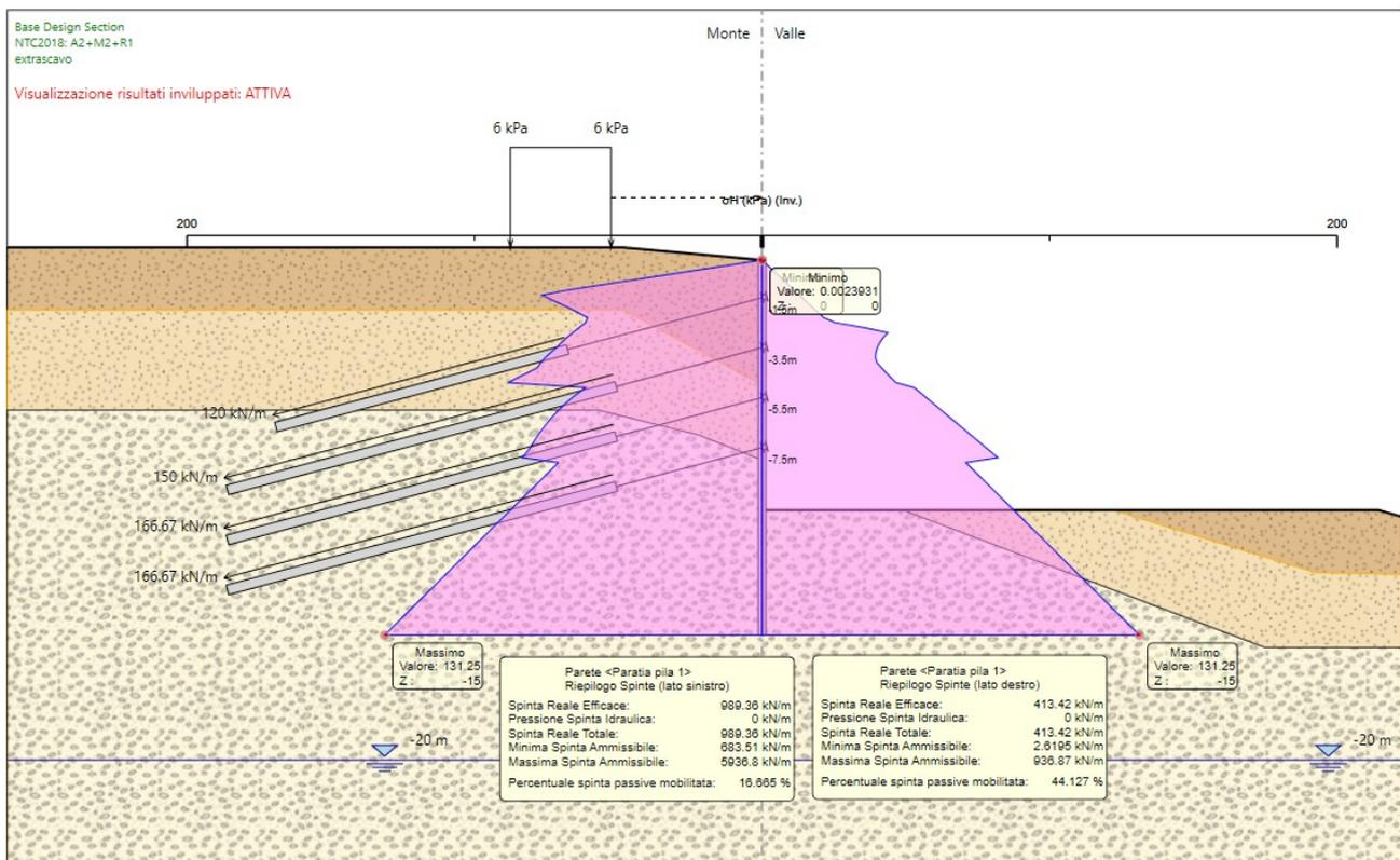
**Figura 26 :  $\sigma'_h$  nel diaframma [kN/m] – comb. SLU – A2+M2+R1 – fase di esercizio**
