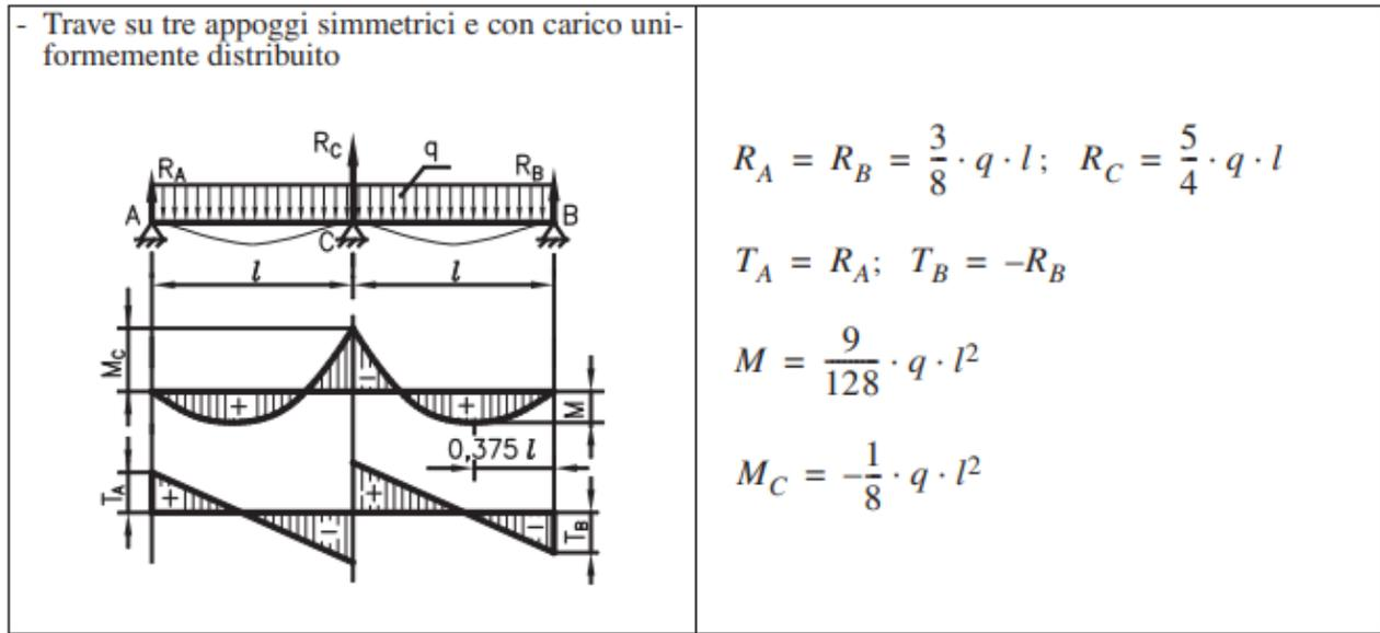
**Figura 24: schema statico considerato per lo studio delle travi di ripartizione**
