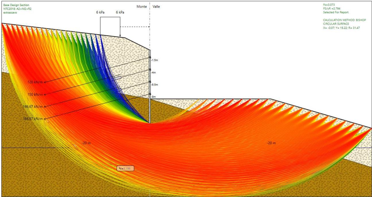
**Figura 26 : superfici di scorrimento analizzate – comb. SLU - A2 + M2 + R2**
