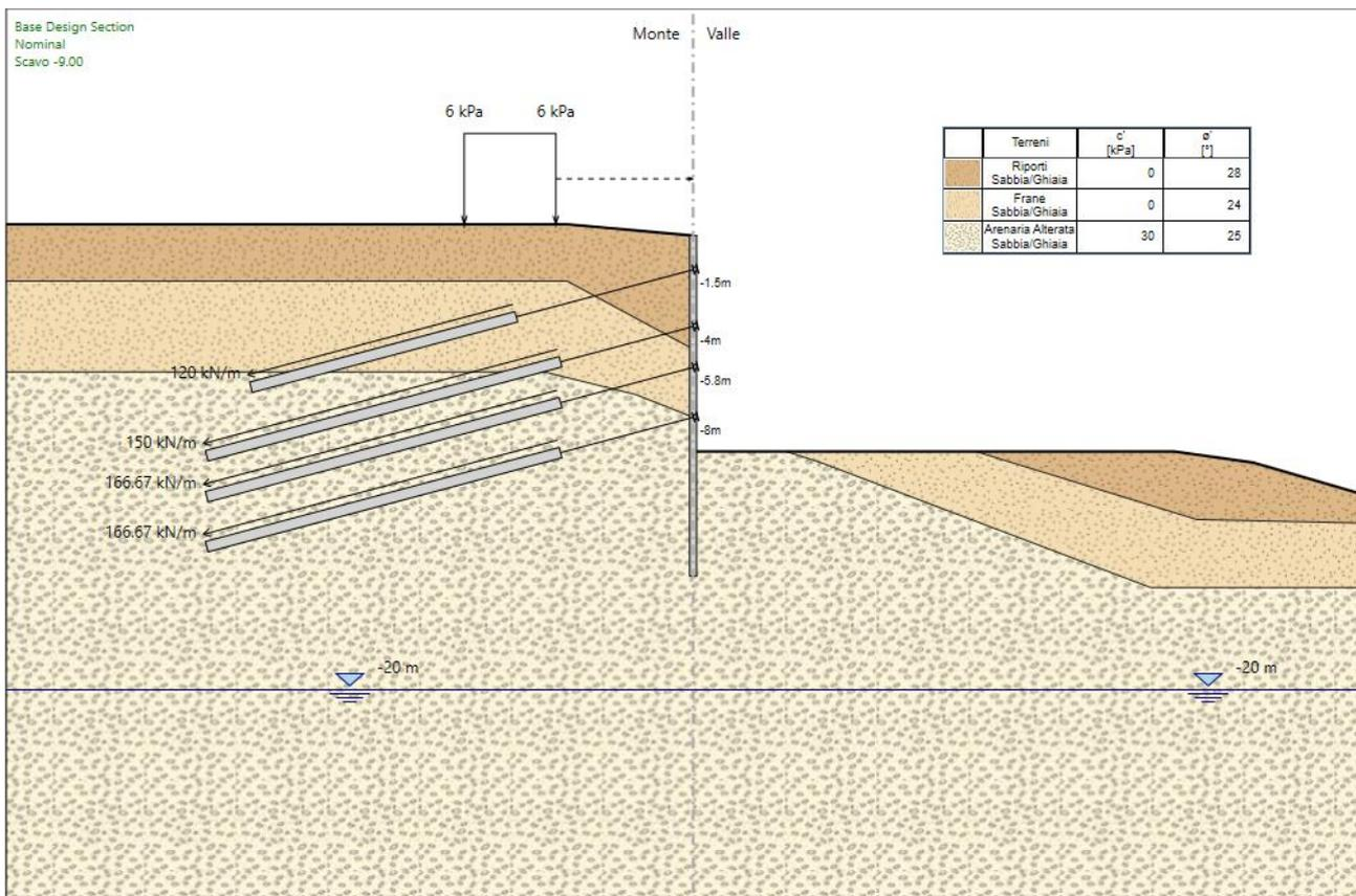
Figura 4 : schema del modello di calcolo adottato
