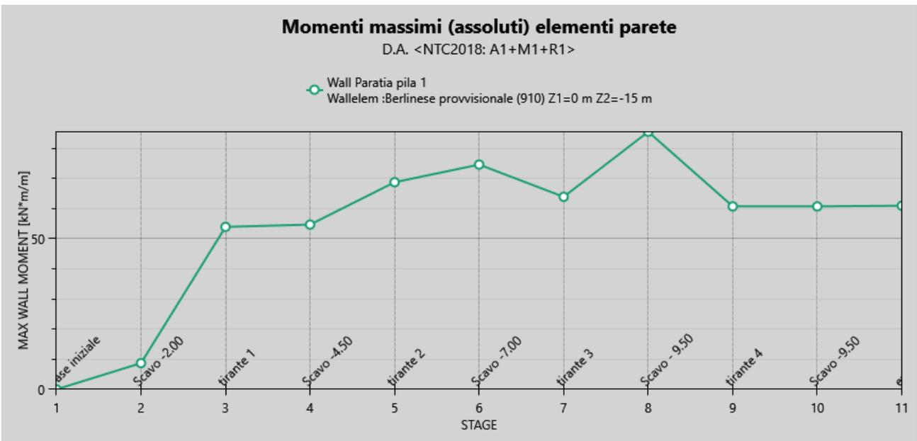
**Figura 20: inviluppo del momento flettente per la combinazione A1+M1+R1 per gli step da 1 a 11 (scavo completato + extrascavo)**
