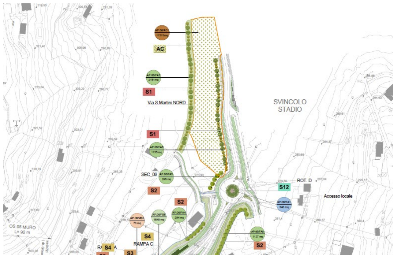
Figura 8.11 Area di cantiere CB01. Sulla sinistra la predisposizione di un filare alberato propedeutica all'installazione del cantiere
