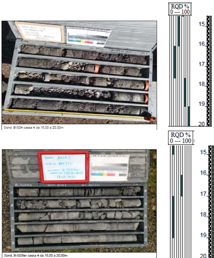
Figura 6-11 Fotografie delle cassette di sondaggio dei sondaggi: BS03ter alla profondità tra 15.0÷20.0 e B_S04 tra 15.0÷20.0
