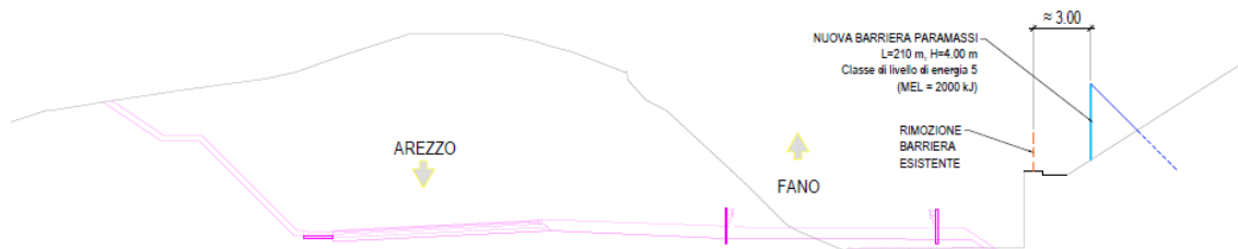
Figura 7-57 Sezione tipologica intervento tra prog. 5+200 a prog. 5+300
