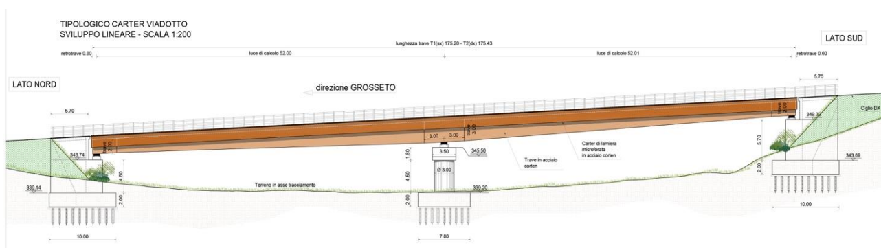
Figura 9.9 Profilo longitudinale tipologico dei viadotti
