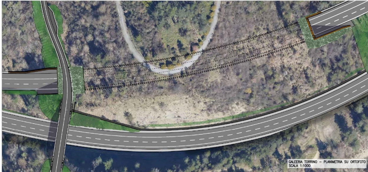
Figura 9.15 Planimetria della galleria Torrino GA02 - GA03 e tratto galleria naturale GN01 in linea tratteggiata
