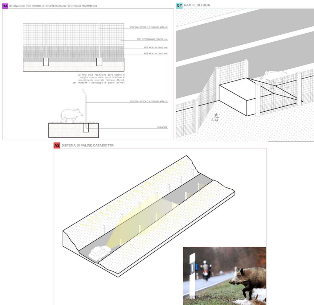
Figura 6.10 Stralcio dei tombini di attraversamento faunistico e dei sistemi utilizzati per la protezione de la fauna
