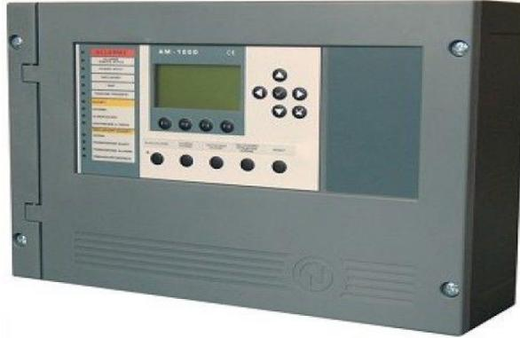
La centrale rilevazione incendi è una centrale di allarme a microprocessore per la gestione di sistemi antincendio di tipo indirizzato, sviluppata secondo le normative EN- 54.2 e EN- 54.4. Nella configurazione base, la centrale presenta 8 linee, ed è espandibile fino a 16 linee.
