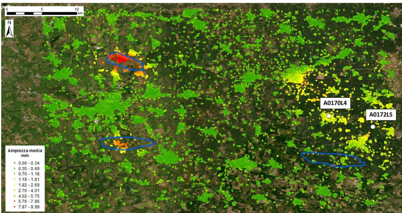
Fig. 34 Dataset RSAT-SNT. Valori di ampiezza media della stagionalità per la componente verticale del rilievo Regional; in blu la proiezione in superficie dei giacimenti di Sergnano (a NO), Ripalta (a SO) e Bordolano (a SE).
