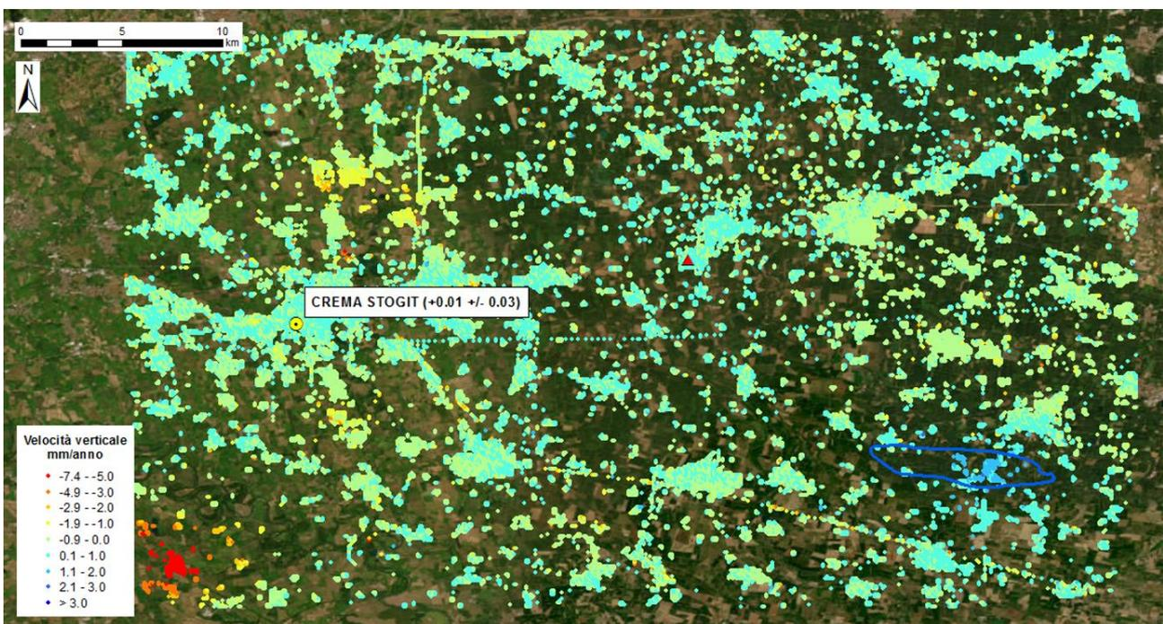
Fig. 25 Dati Regional SNT scomposti secondo il vettore verticale prima della calibrazione. In evidenza il punto di riferimento utilizzato per la scomposizione del vettore velocità (triangolo rosso) e il CGPS Stogit di Crema (giallo); in blu la proiezione in superficie del giacimento.
