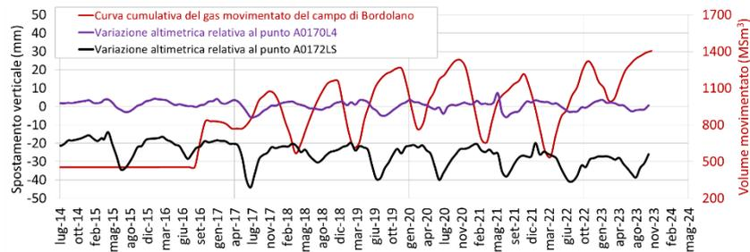
Fig. 36 Confronto tra l'andamento temporale delle variazioni altimetriche di due punti nell'area a nord del campo di Bordolano e la curva del gas movimentato del giacimento (ubicazione in Fig. 34).
