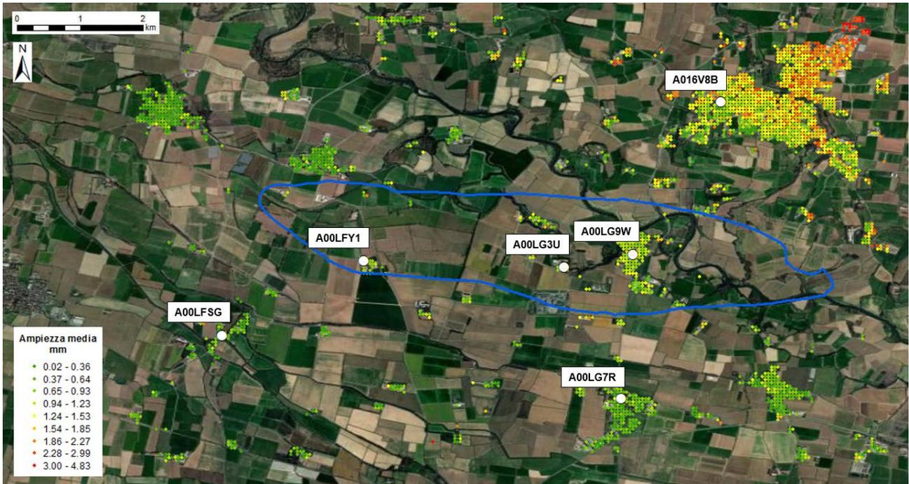
Fig. 37 Dataset RSAT-SNT. Valori medi di ampiezza della stagionalità calcolati per la componente verticale dei PS Local. In figura è visualizzata anche l'ubicazione dei 6 punti scelti per l'analisi delle serie storiche rispetto alla proiezione in superficie del giacimento (si veda Cap. 3.3).
