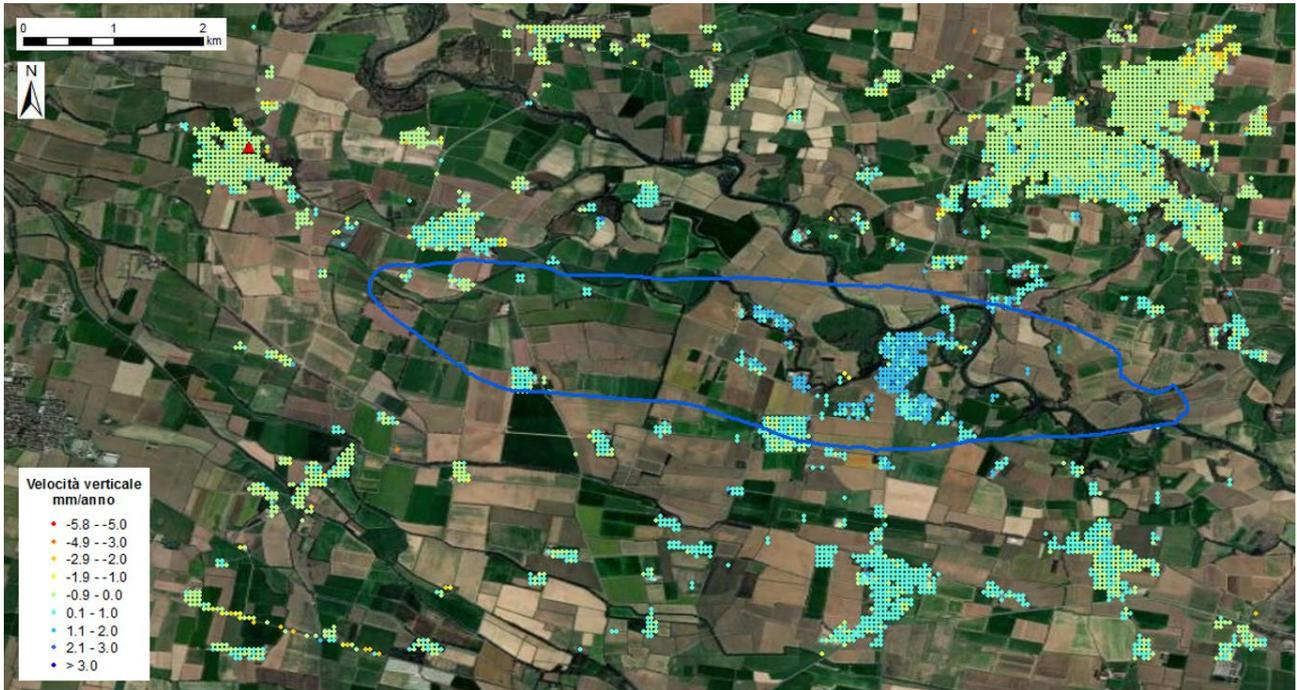
Fig. 32 Dati Local SNT scomposti secondo il vettore verticale e calibrati. In evidenza il punto di riferimento utilizzato per la scomposizione del vettore velocità (triangolo rosso) e la proiezione in superficie del giacimento.
