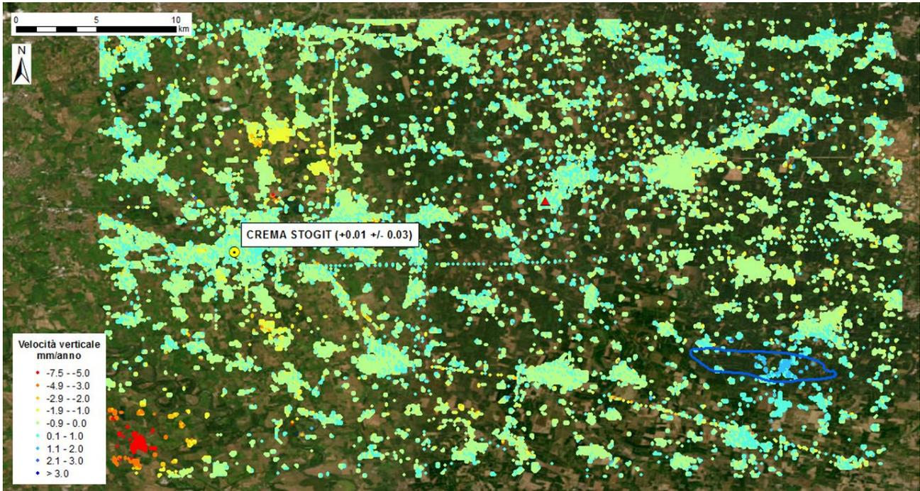
Fig. 28 *Dati Regional SNT scomposti secondo il vettore verticale e calibrati. In evidenza l'ubicazione del CGPS usato per la calibrazione e il punto di riferimento (triangolo rosso); in blu la proiezione in superficie del giacimento.*
