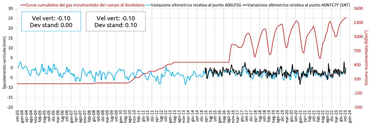
Fig. 44 Confronto tra l'andamento temporale delle variazioni altimetriche dei punti scomposti A00LFSG (RSAT-SNT) e A0NTC7Y (SNT), e la curva cumulativa di stoccaggio del giacimento di Bordolano.
