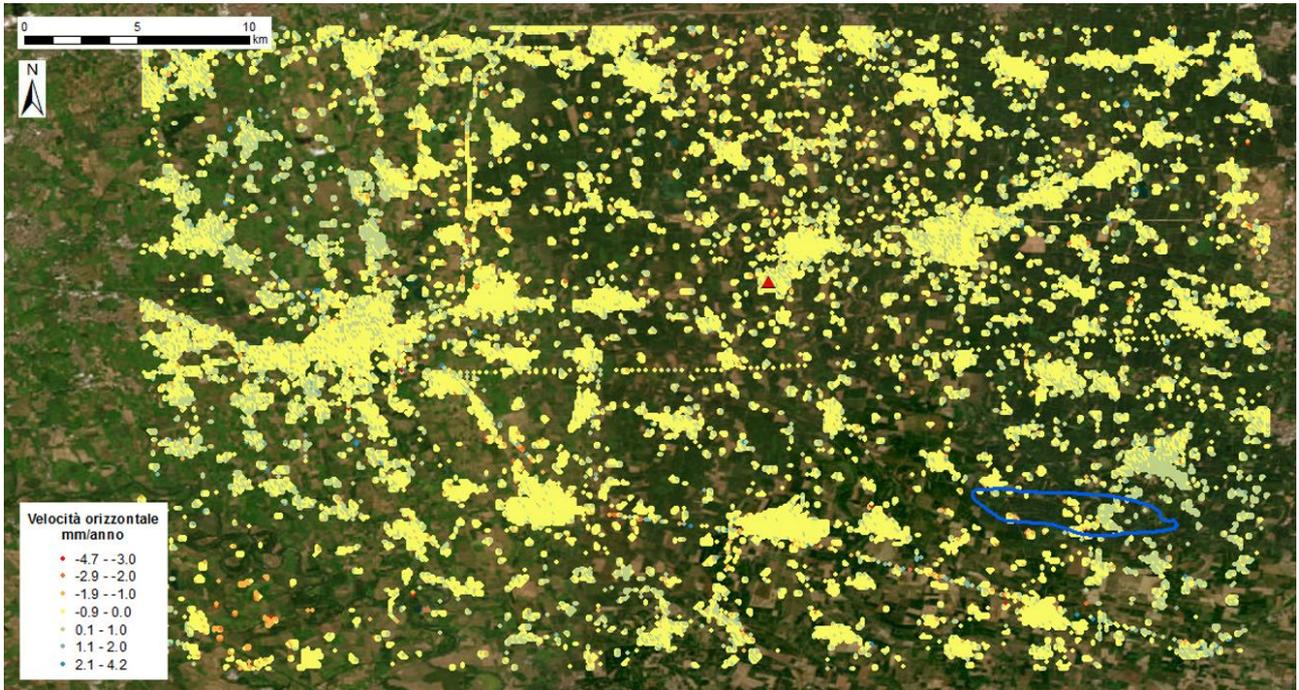
Fig. 26 Dati Regional SNT scomposti secondo il vettore orizzontale. In evidenza il punto di riferimento utilizzato per la scomposizione del vettore velocità (triangolo rosso); in blu la proiezione in superficie del giacimento.
