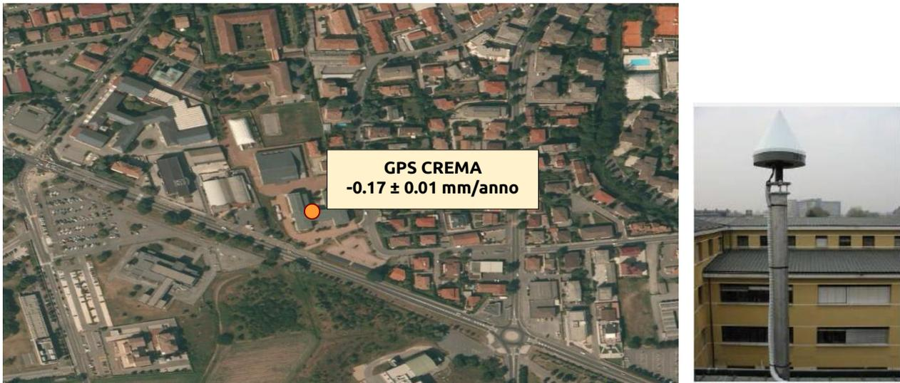
Fig. 8 Ubicazione del GPS pubblico di Crema e particolare dell'antenna.
