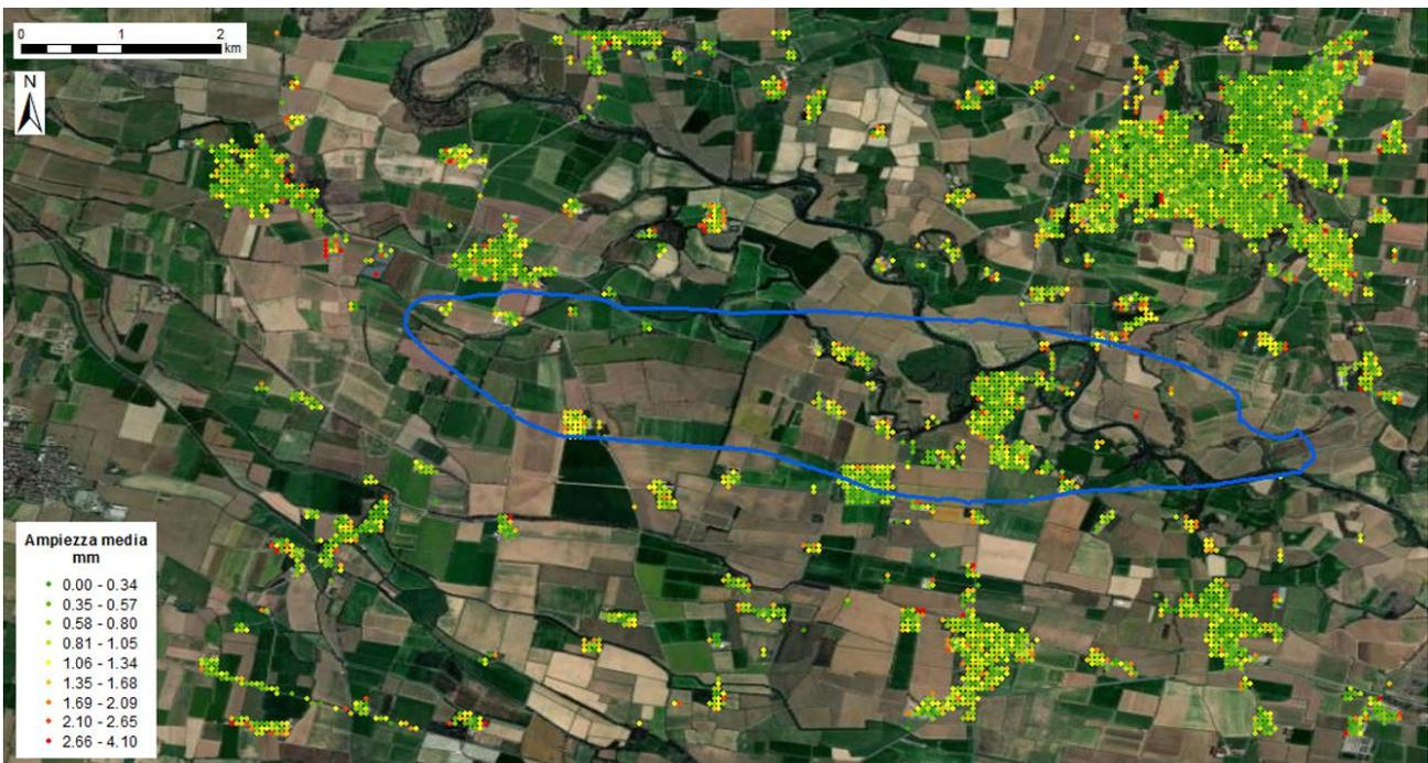
Fig. 40 Dataset SNT. Valori medi di ampiezza della stagionalità calcolati per la componente orizzontale dei PS Local; in blu la proiezione in superficie del giacimento.
