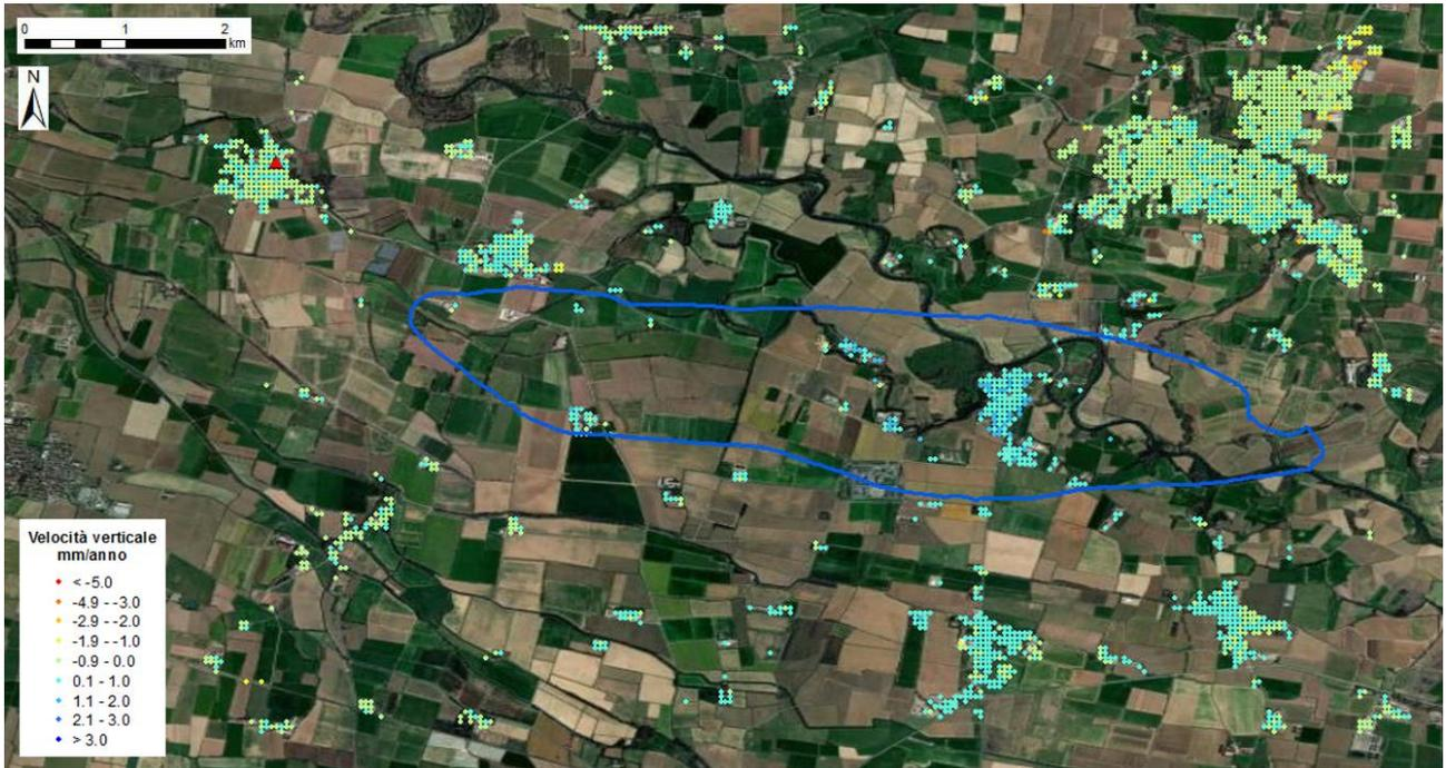
Fig. 18 Dati Local RSAT-SNT scomposti secondo il vettore verticale prima della calibrazione. In evidenza il punto di riferimento utilizzato per la scomposizione del vettore velocità (triangolo rosso) e la proiezione in superficie del giacimento.
