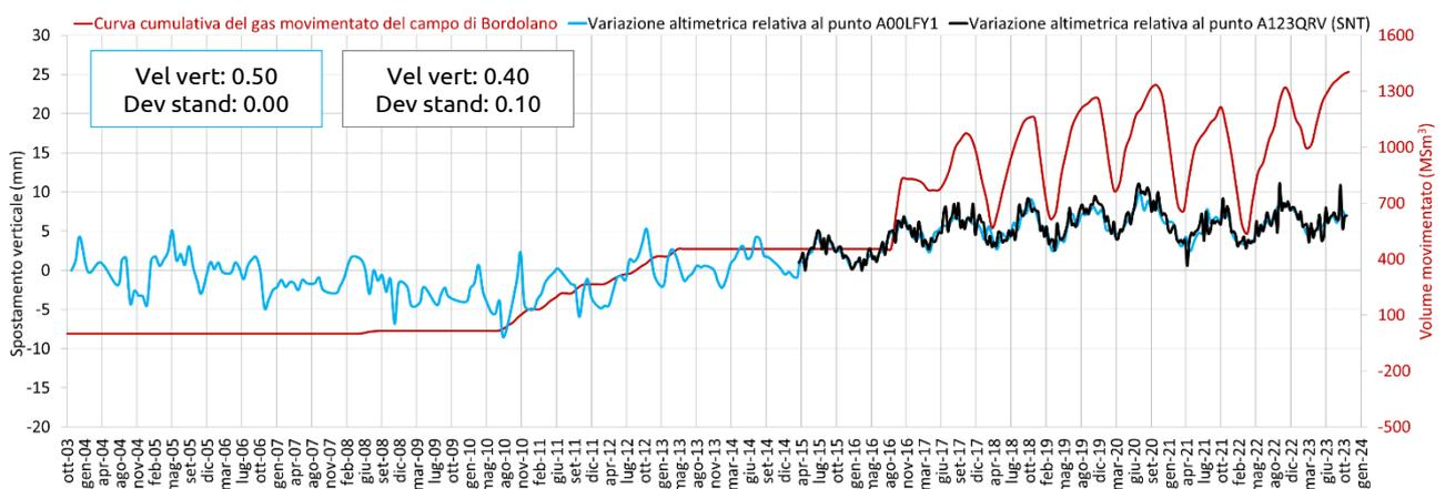
Fig. 41 Confronto tra l'andamento temporale delle variazioni altimetriche dei punti scomposti A00LFY1 (RSAT-SNT) e A123QRV (SNT), e la curva cumulativa di stoccaggio del giacimento di Bordolano.
