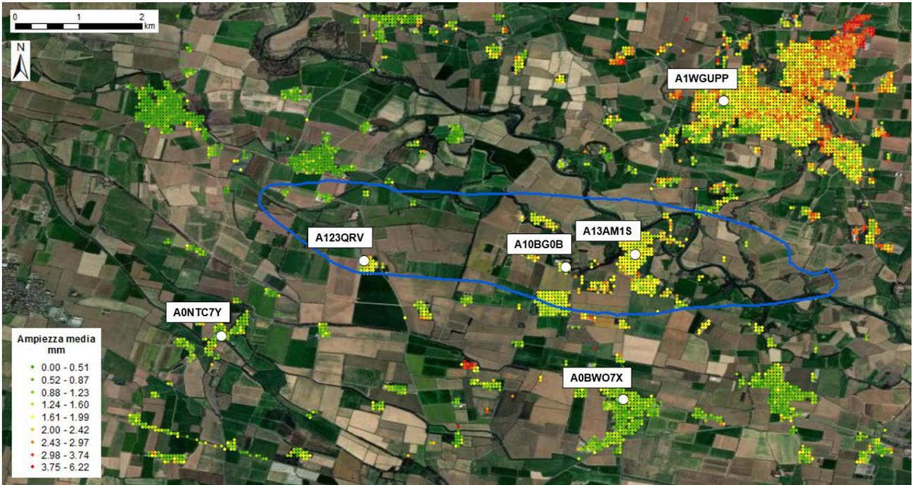
Fig. 39 Dataset SNT. Valori medi di ampiezza della stagionalità calcolati per la componente verticale dei PS Local. In figura è visualizzata anche l'ubicazione dei 6 punti scelti per l'analisi delle serie storiche rispetto alla proiezione in superficie del giacimento (si veda Cap. 3.3).
