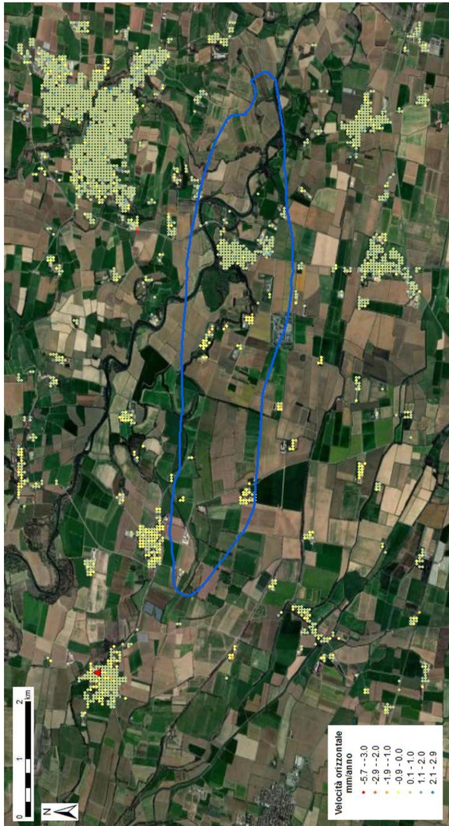
Fig. 22 Dati Local RSAT-SNT scomposti secondo il vettore orizzontale. In evidenza il punto di riferimento utilizzato per la scomposizione del vettore velocità (triangolo rosso) e la proiezione in superficie del giacimento.
