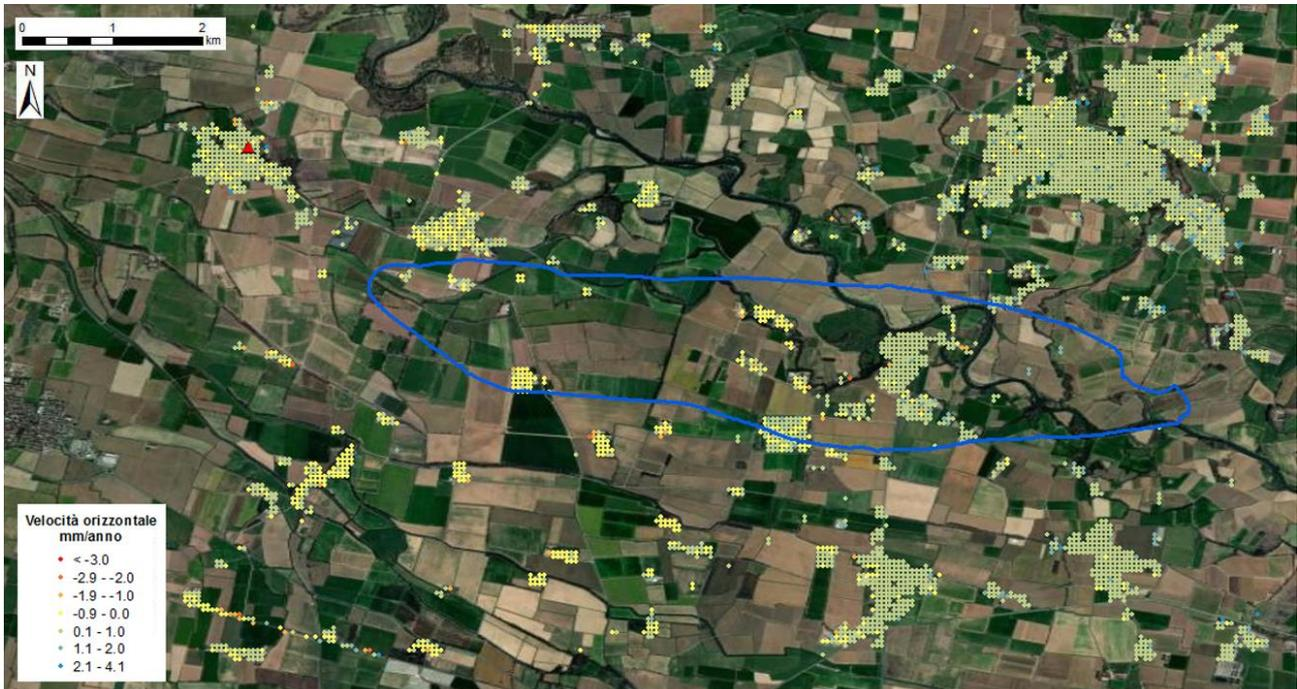
Fig. 33 Dati Local SNT scomposti secondo il vettore orizzontale. In evidenza il punto di riferimento utilizzato per la scomposizione del vettore velocità (triangolo rosso) e la proiezione in superficie del giacimento.
