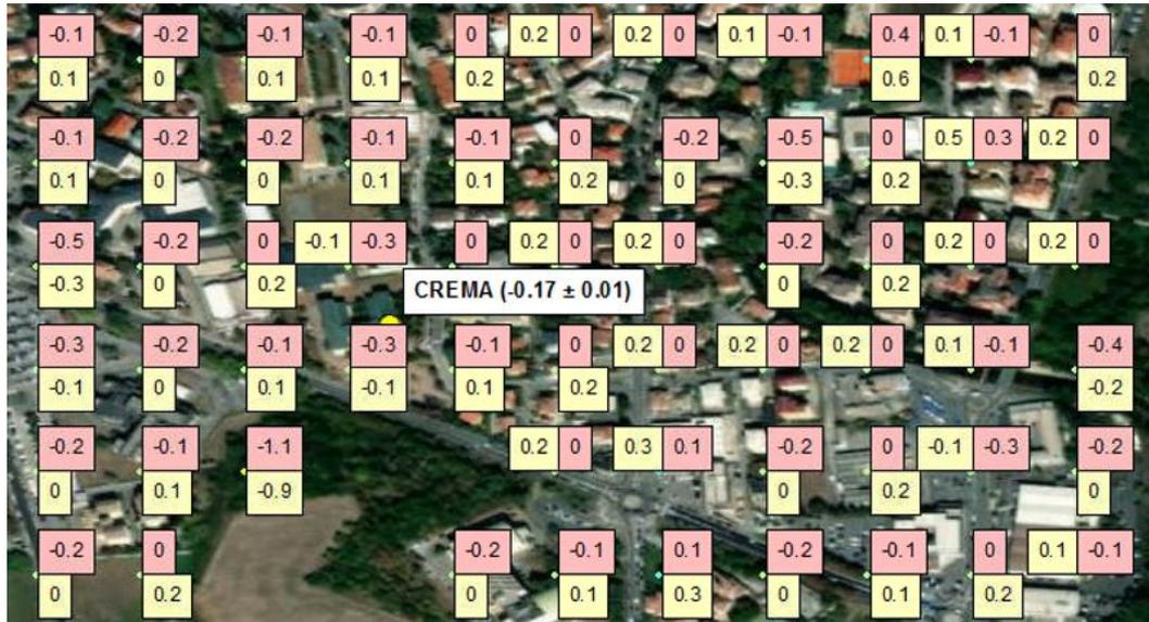
Fig. 12 Punti scomposti dell'analisi Regional: in giallo i valori di velocità verticale originali e in rosa quelli calibrati.
