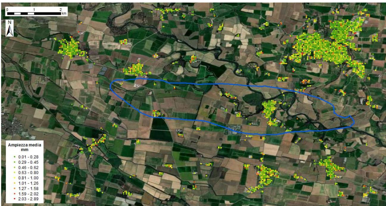
Fig. 38 Dataset RSAT-SNT. Valori medi di ampiezza della stagionalità calcolati per la componente orizzontale dei PS Local; in blu la proiezione in superficie del giacimento.
