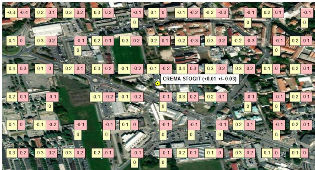
Fig. 27 Punti scomposti dell'analisi Regional: in giallo i valori di velocità verticale originali e in rosa quelli calibrati.
