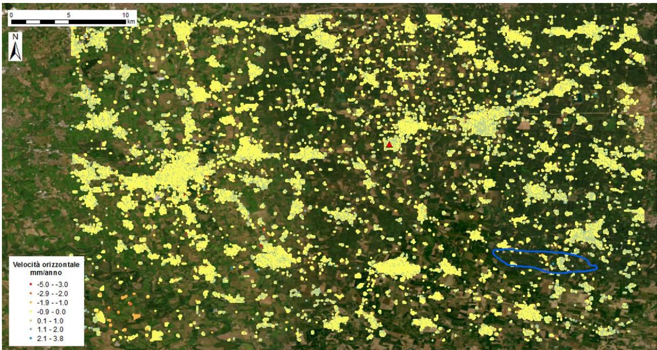
Fig. 11 *Dati Regional RSAT-SNT scomposti secondo il vettore orizzontale. In evidenza il punto di riferimento utilizzato per la scomposizione del vettore velocità (triangolo rosso). In blu la proiezione in superficie del giacimento.*
