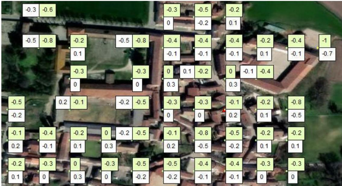
Fig. 20 Visualizzazione del punto di riferimento dell'analisi Local (triangolo rosso) ed indicazione dei valori di velocità verticale originali (in bianco) e calibrati (in verde).
