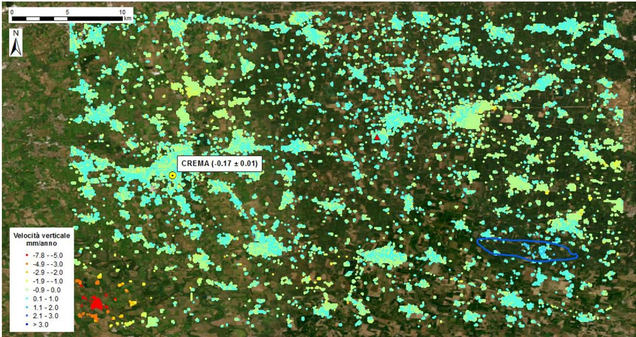
Fig. 10 *Dati Regional RSAT-SNT scomposti secondo il vettore verticale prima della calibrazione. In evidenza il punto di riferimento utilizzato per la scomposizione del vettore velocità (triangolo rosso) e il CGPS pubblico di Crema (giallo). In blu la proiezione in superficie del giacimento.*
