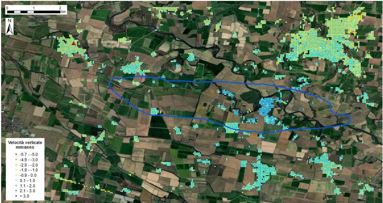
Fig. 29 Dati Local SNT scomposti secondo il vettore verticale prima della calibrazione. In evidenza il punto di riferimento utilizzato per la scomposizione del vettore velocità (triangolo rosso) e la proiezione in superficie del giacimento.
