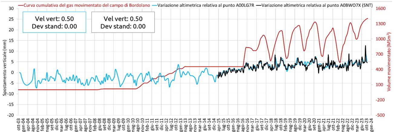
Fig. 46 Confronto tra l'andamento temporale delle variazioni altimetriche dei punti scomposti A00LG7R (RSAT-SNT) e A0BWO7X (SNT), e la curva cumulativa di stoccaggio del giacimento di Bordolano.
