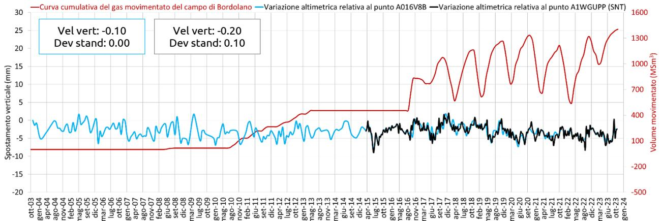
Fig. 45 Confronto tra l'andamento temporale delle variazioni altimetriche dei punti scomposti A016V8B (RSAT-SNT) e A1WGUPP (SNT), e la curva cumulativa di stoccaggio del giacimento di Bordolano.
