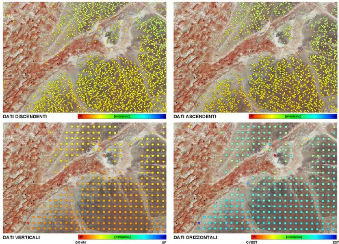
Fig. 3 Trasformazione dei dati di spostamento dei PS su griglia regolare. In alto i risultati ottenuti dai PS, in basso gli stessi ricampionati su griglia regolare per la scomposizione del moto.
