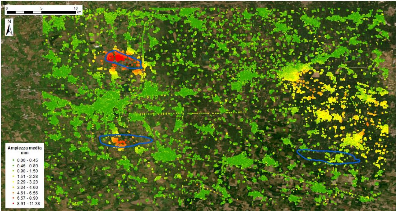
Fig. 35 Dataset SNT. Valori di ampiezza media della stagionalità per la componente verticale del rilievo Regional; in blu la proiezione in superficie dei giacimenti di Sergnano (a NO), Ripalta (a SO) e Bordolano (a SE).
