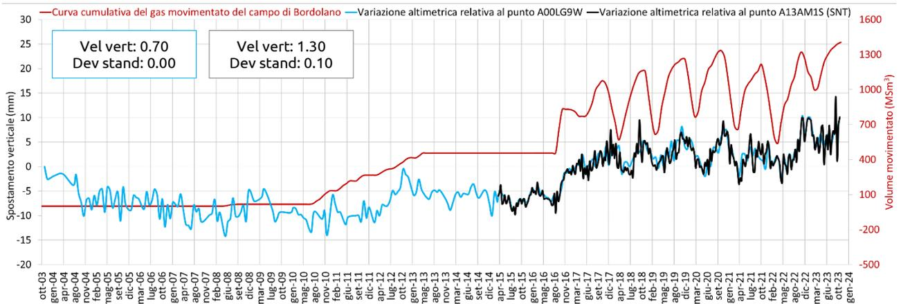
Fig. 43 Confronto tra l'andamento temporale delle variazioni altimetriche dei punti scomposti A00LG9W (RSAT-SNT) e A13AM1S (SNT), e la curva cumulativa di stoccaggio del giacimento di Bordolano.
