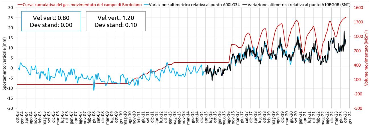
Fig. 42 Confronto tra l'andamento temporale delle variazioni altimetriche dei punti scomposti A00LG3U (RSAT-SNT) e A10BG0B (SNT), e la curva cumulativa di stoccaggio del giacimento di Bordolano.
