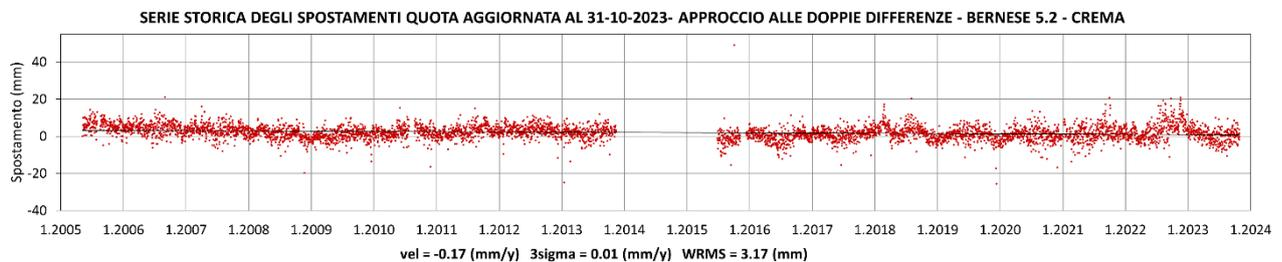
Fig. 9 Stima di velocità della componente verticale per il GPS pubblico di Crema.
