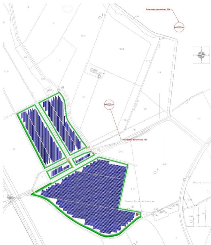
*Figura 2- Riduzione area impianto FV a causa dell'ombreggiamento generato dalle pale eoliche T06 e T07*
