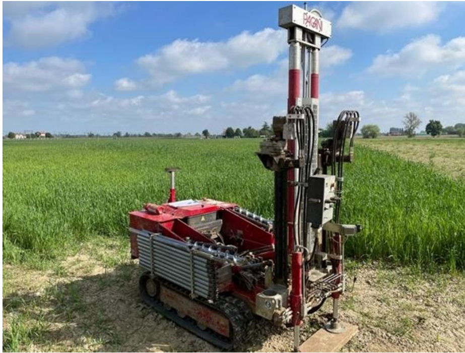
Figura 6-10 - Strumento utilizzato per le indagini PAGANI TG 63
