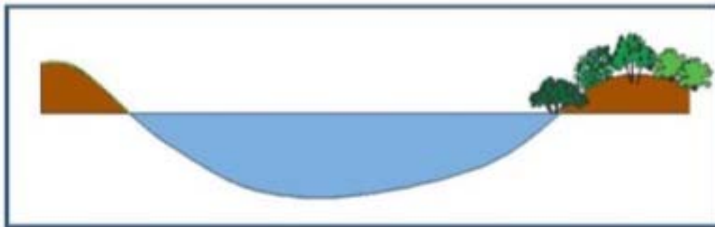
Figura 139 - Inerbimento sponde con miscela per idrosemina e piantumazione di arbusti
