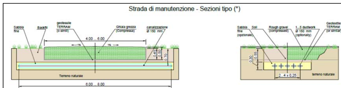
Figura 17 Sezioni stradali di campo
