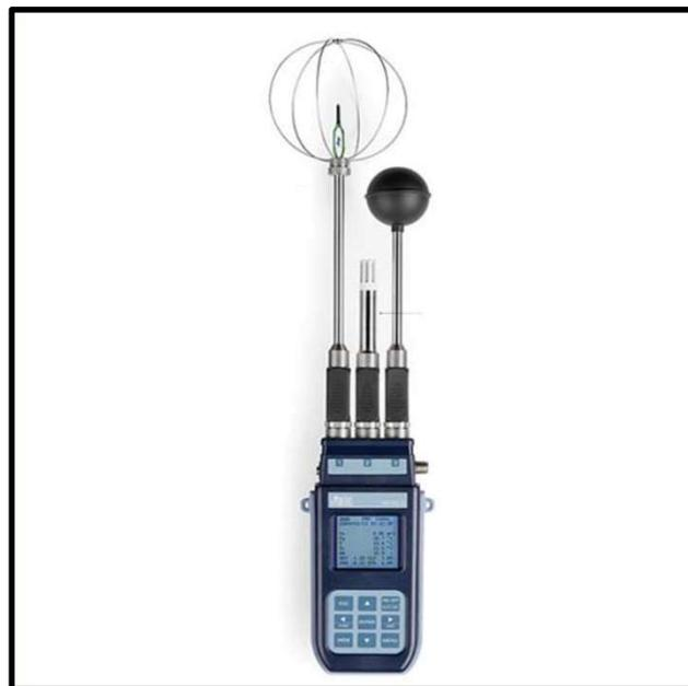
Strumentazione modulare per la misurazione del microclima
