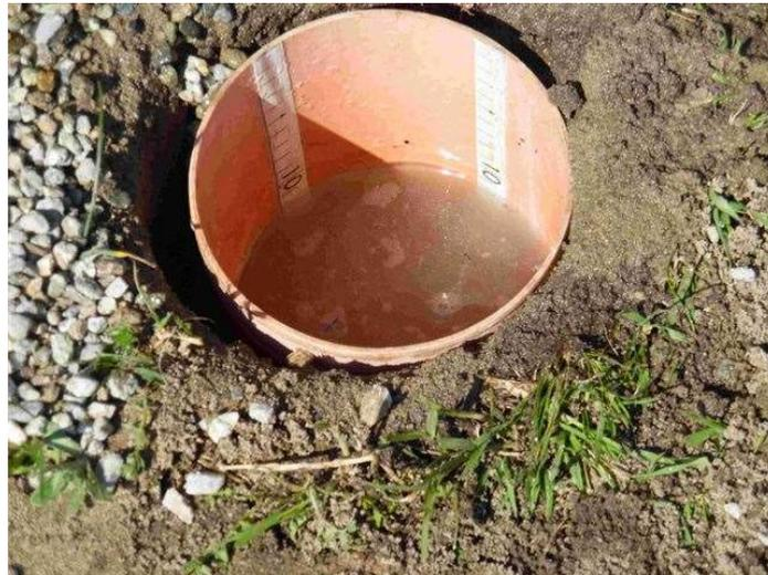
*Prova di Permeabilità superficiale*
