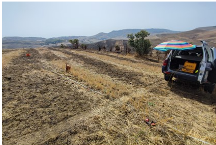
Figura 17 – Particolare dello stendimento sismico e della stazione sismica digitale
