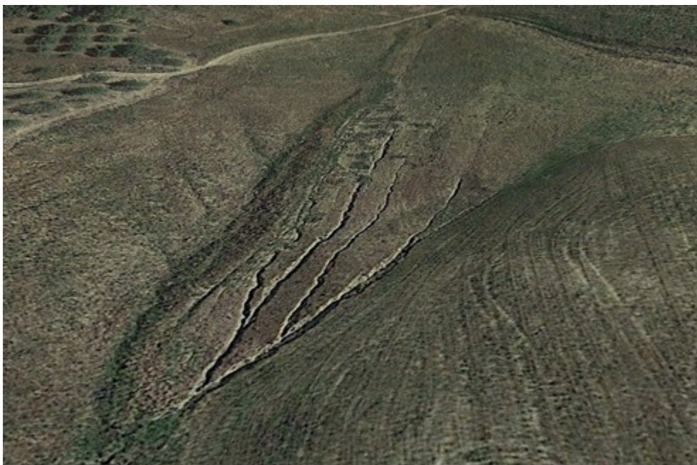
Figura 10 – Fenomeni di erosione areale da parte delle acque selvagge
