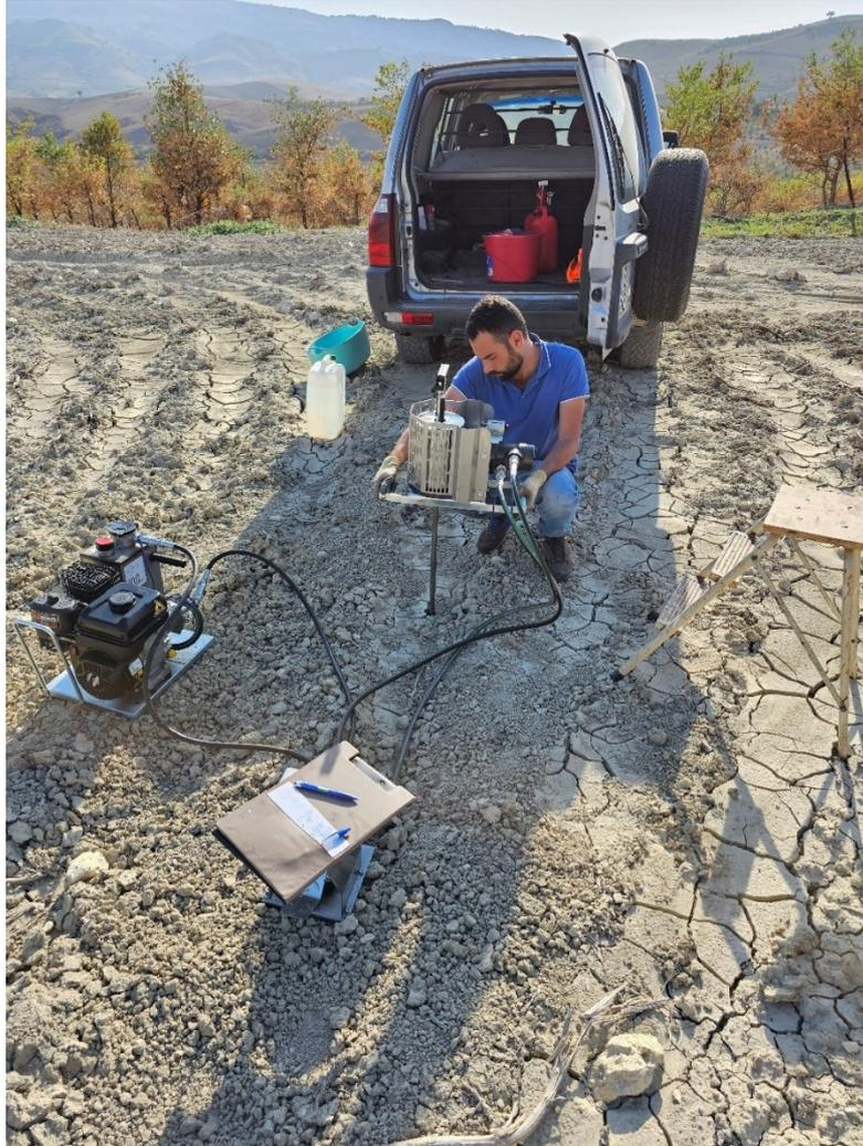
*Figura 55 – Fase di esecuzione della prova penetrometrica DP4.*
