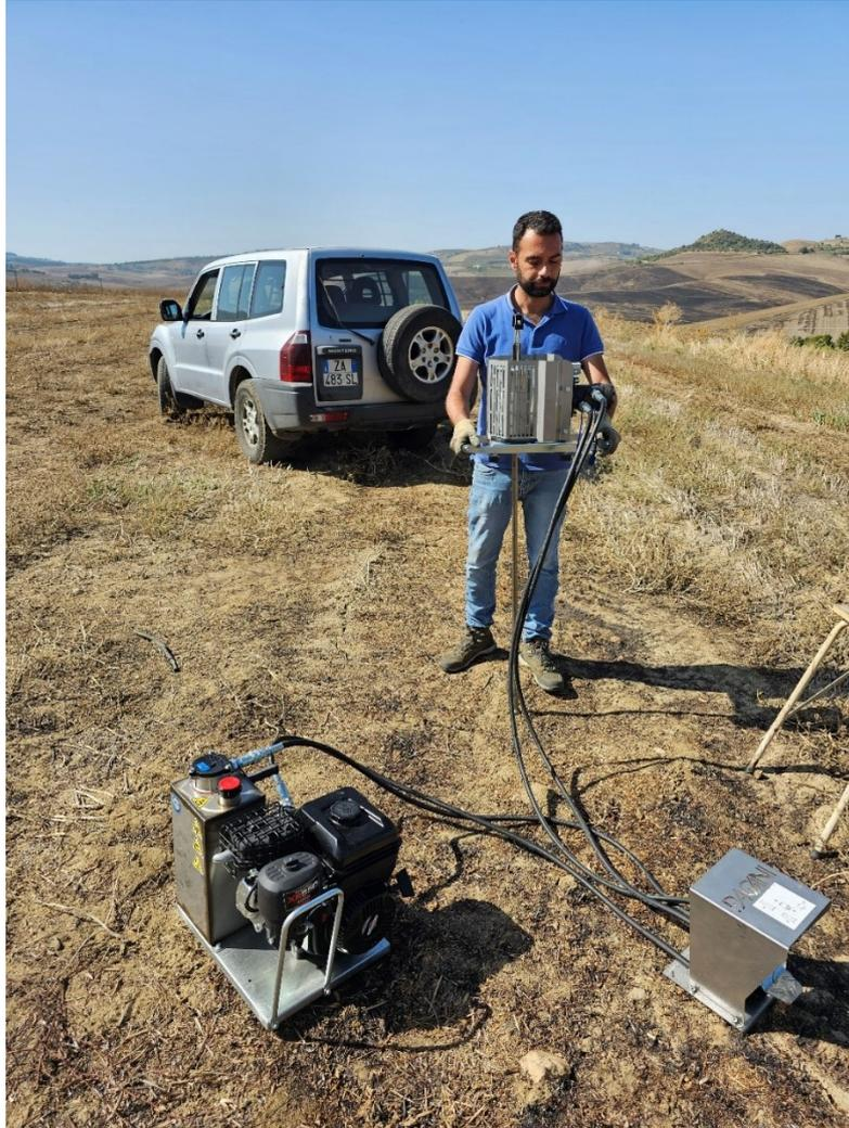
Figura 54 – Fase di esecuzione della prova penetrometrica DP3.
