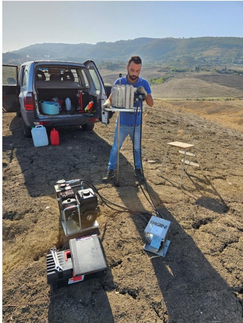
Figura 52 – Fase di esecuzione della prova penetrometrica DP1.
