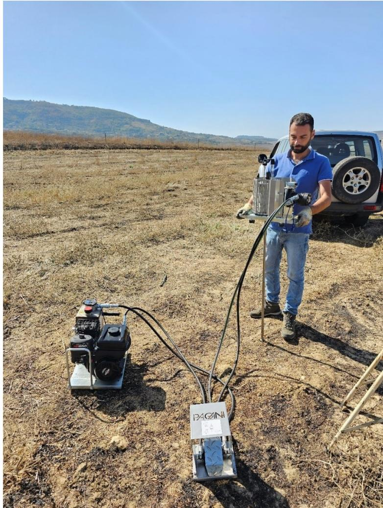
Figura 53 Fase di acquisizione della prova penetrometrica DP2.
