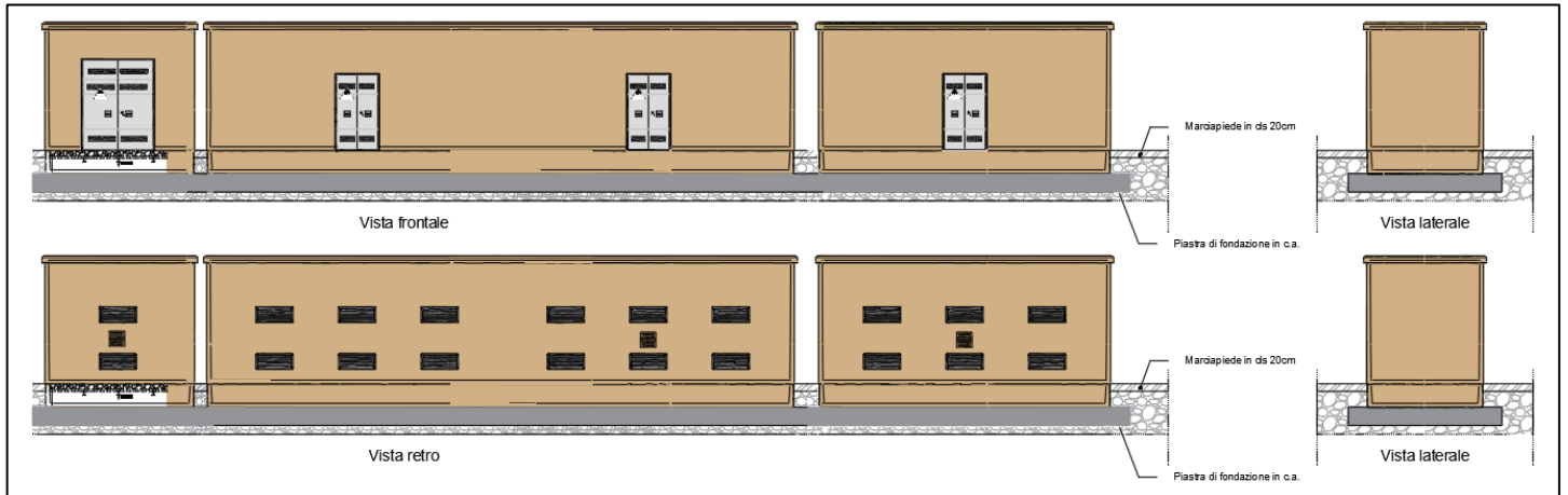
Figura 16 Cabine di trasformazione - Prospetti
