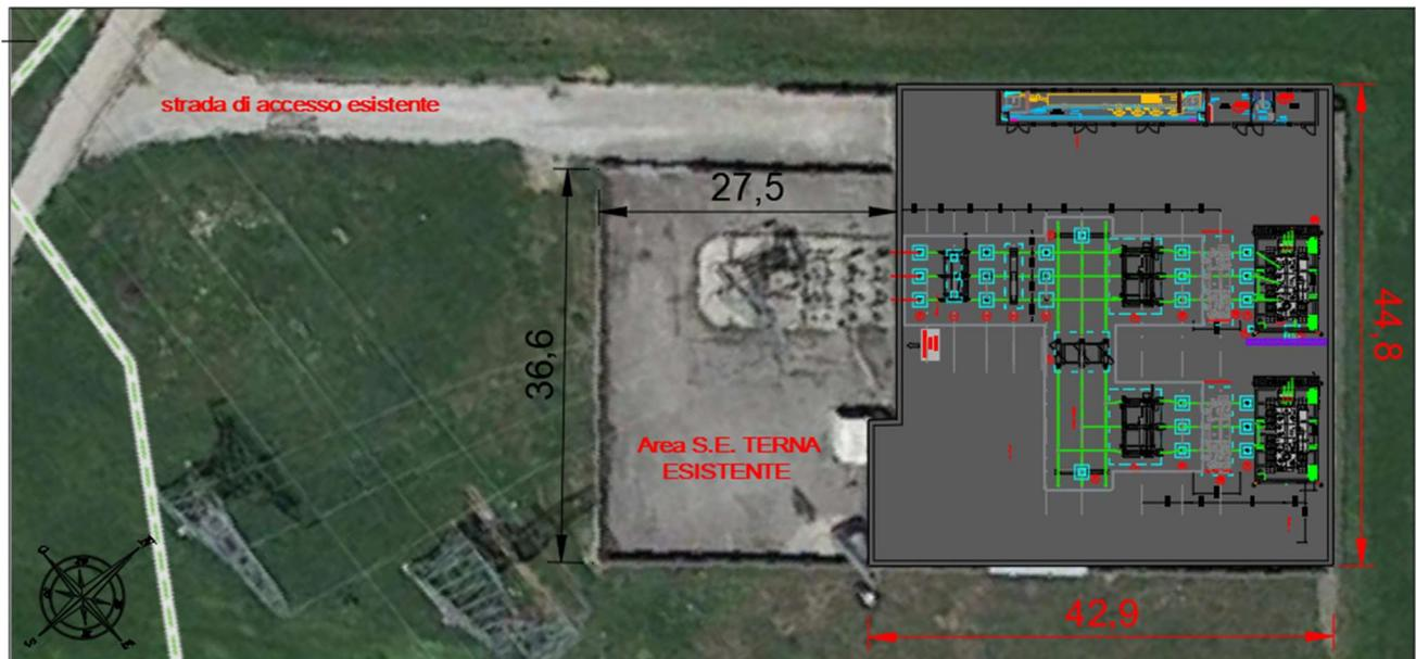
**Fig. 3. Planimetria elettromeccanica della sottostazione**
