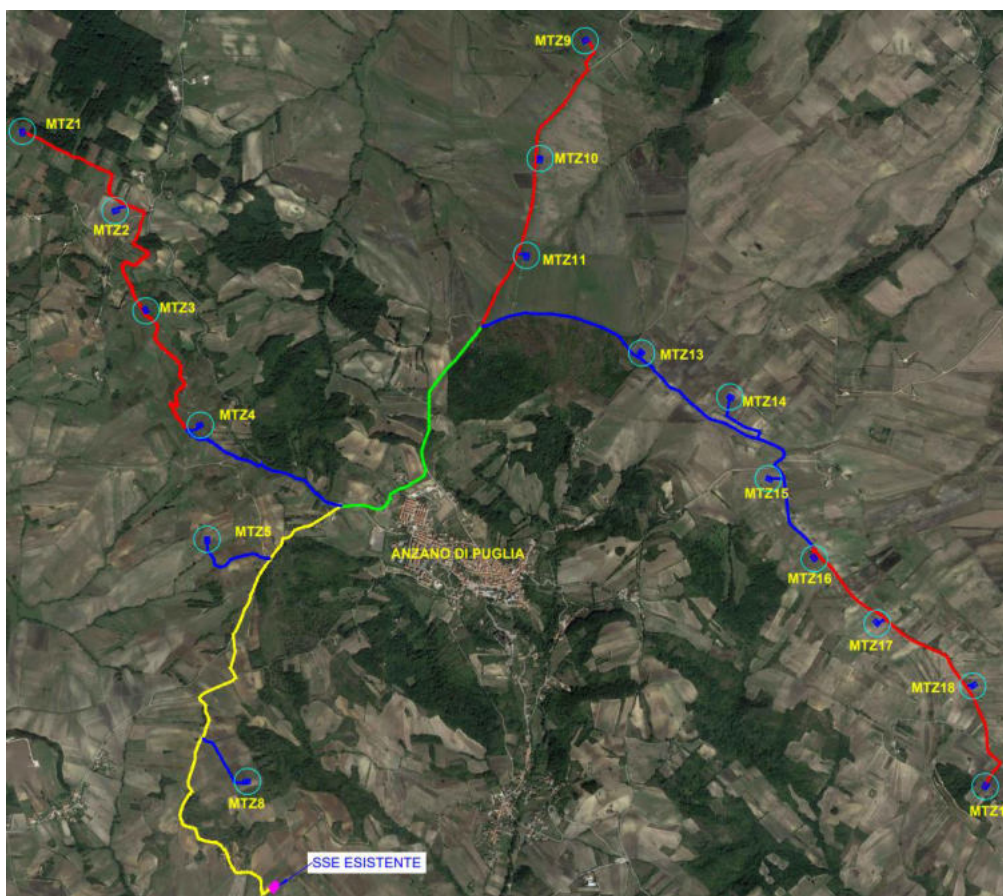
Figura 1.2. – Impianto eolico di progetto.
