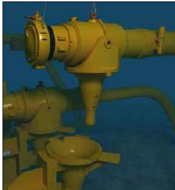
**Figura A 3-16: sistema di Tie-in orizzontale (a sinistra) e in Stabcon (a destra)**
