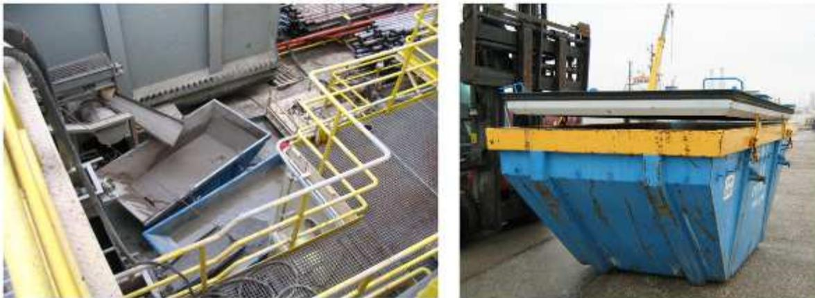
**Figura A 3-9: cassonetto per detriti sotto lo scivolo dei vibrovagli (a sinistra) e particolare del coperchio a tenuta (a destra)**
