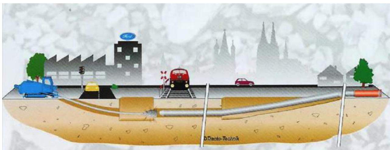
Figura 6.16. – Schema di principio dell'attraversamento in T.O.C.
