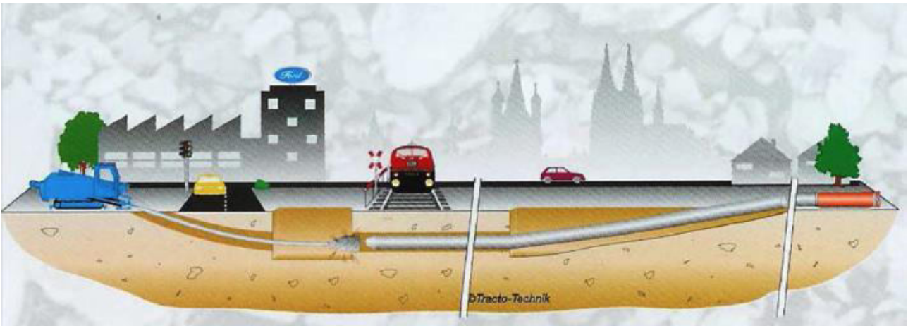
Figura 9. Schema di principio dell'attraversamento in T.O.C.
