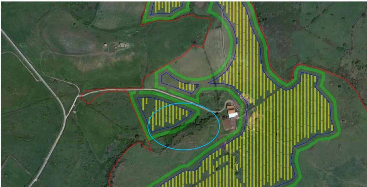
**Figura 36 – Estratto del Layout di impianto in cui si mette in evidenza l'interferenza del bosco ceduo di olmo con la fascia di mitigazione a verde (poligono in verde elettrico fascia di mitigazione, ellisse in azzurro bosco), Superficie totale (perimetro in rosso), recinzioni (perimetro in blu) ed S<sub>pV</sub> (poligono in giallo).**
