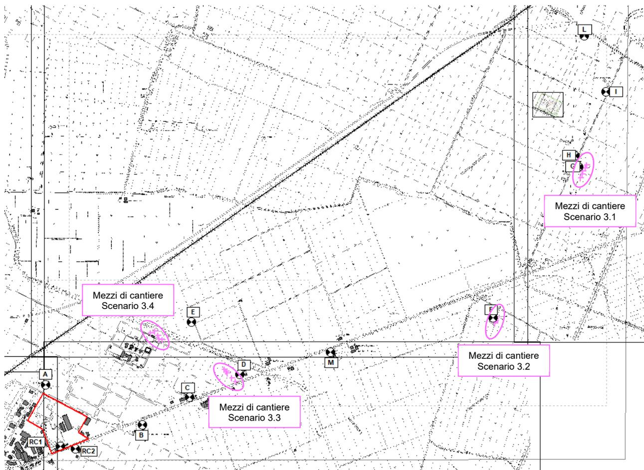
**Figura 5-3 – Posizioni tipo dei mezzi di cantiere necessari alla realizzazione del cavidotto MT - Scenario 3**
