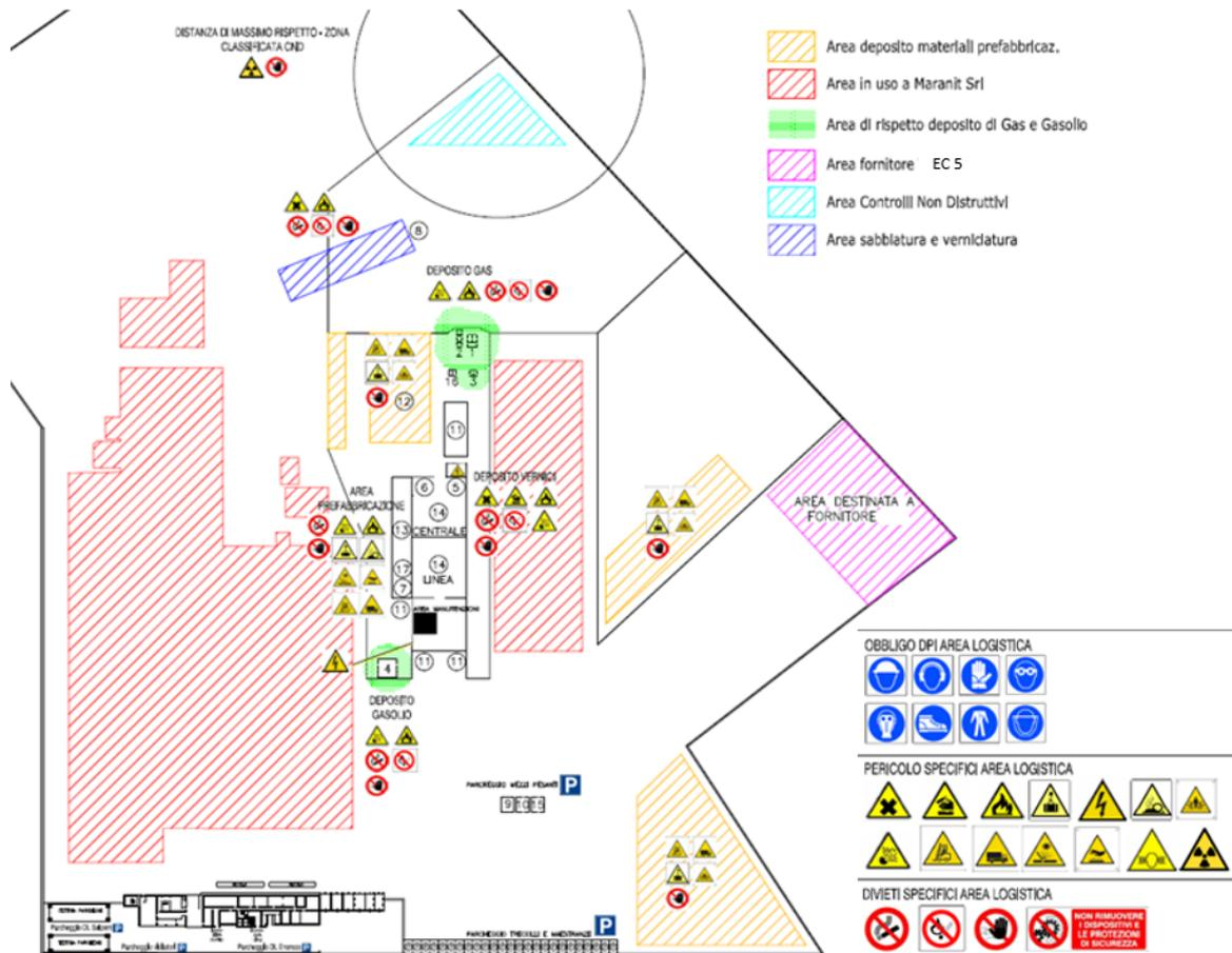
**Figura 5-2 – Layout tipo del cantiere logistico**
