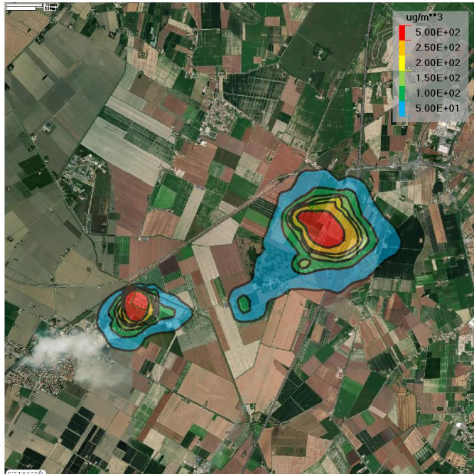
Figura 9-8 Concentrazione di NOx al suolo espresso come 99.8 Percentile associato a tutti i cantieri per il primo anno di lavori.
