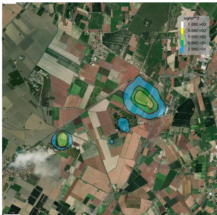
Figura 9-7 Concentrazione di CO al suolo espressa in ug/mc come valore massimo sulle 8 ore, per il primo anno di lavori
