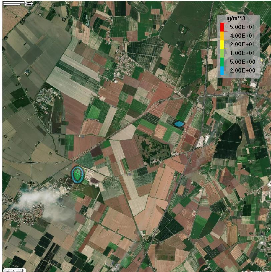
Figura 9-11 Concentrazione di Polveri al suolo espressa in ug/mc come 90.4 Percentile, per il primo anno di lavori
