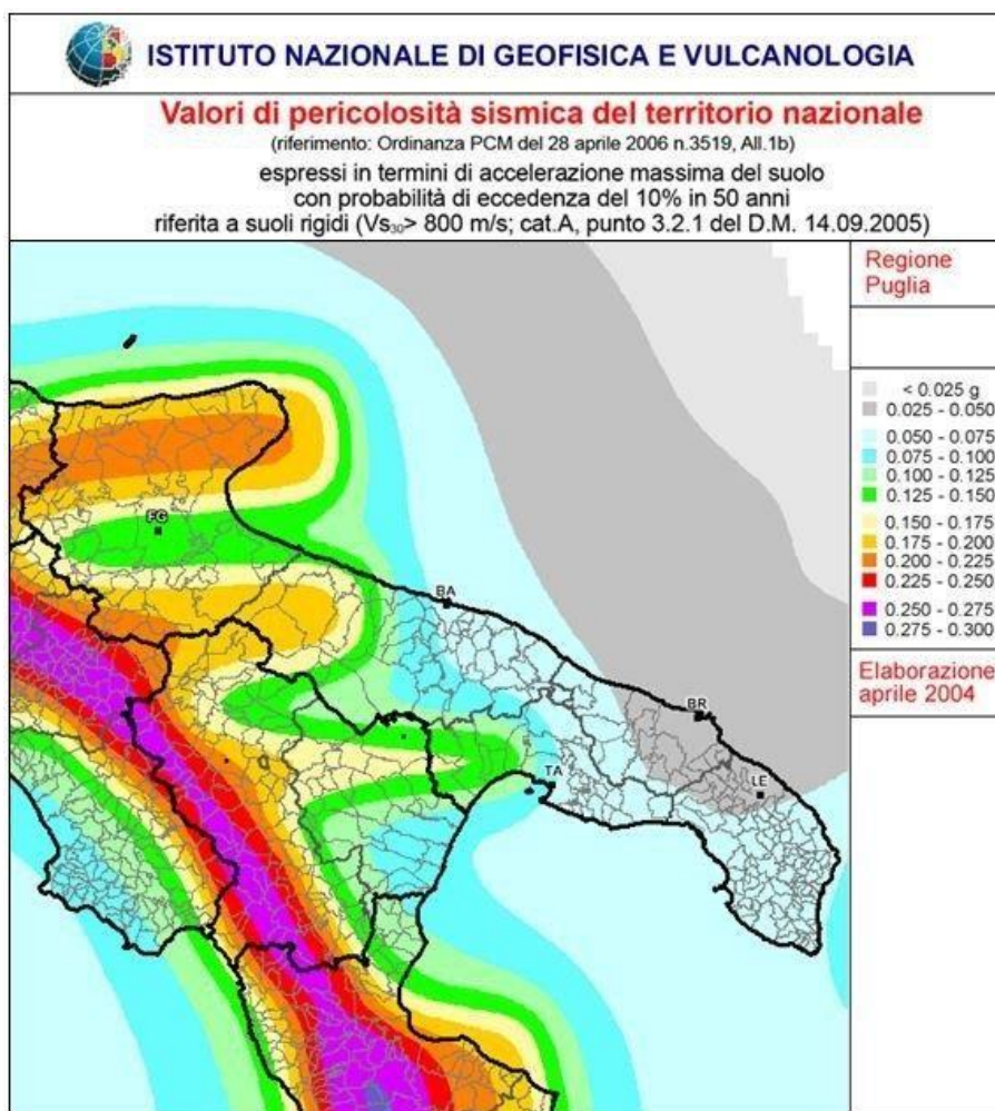
Figura 6-2 Carta della pericolosità sismica della Puglia
