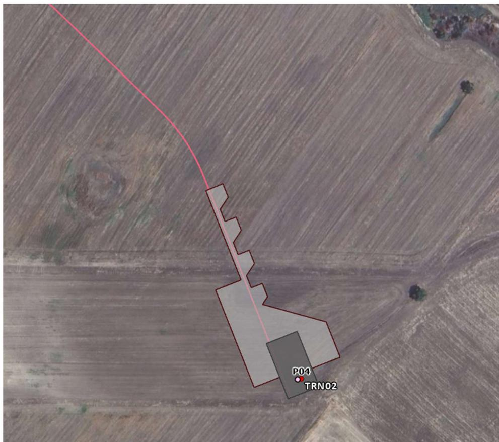
Figura 7-14: Interferenza P04 tra la piazzola di cantiere dell'aerogeneratore TRN02 e l'idrografia.
