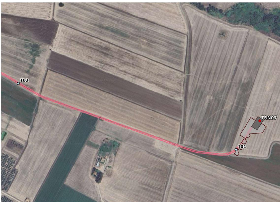
Figura 7-3: Interferenze T01, T02 tra la viabilità di nuova realizzazione e solchi di drenaggio naturali.
