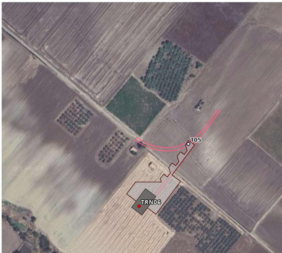
Figura 7-6: Interferenza T05 tra la viabilità di nuova realizzazione e un solco di drenaggio naturale.
