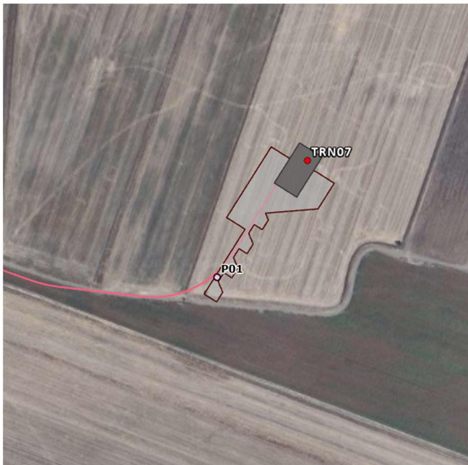
Figura 7-11: Interferenza P01 tra la piazzola di cantiere dell'aerogeneratore TRN07 e l'idrografia.
