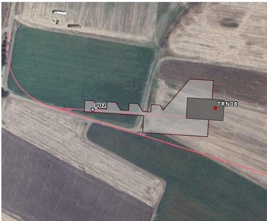
Figura 7-12: Interferenza P02 tra la piazzola di cantiere dell'aerogeneratore TRN08 e l'idrografia.
