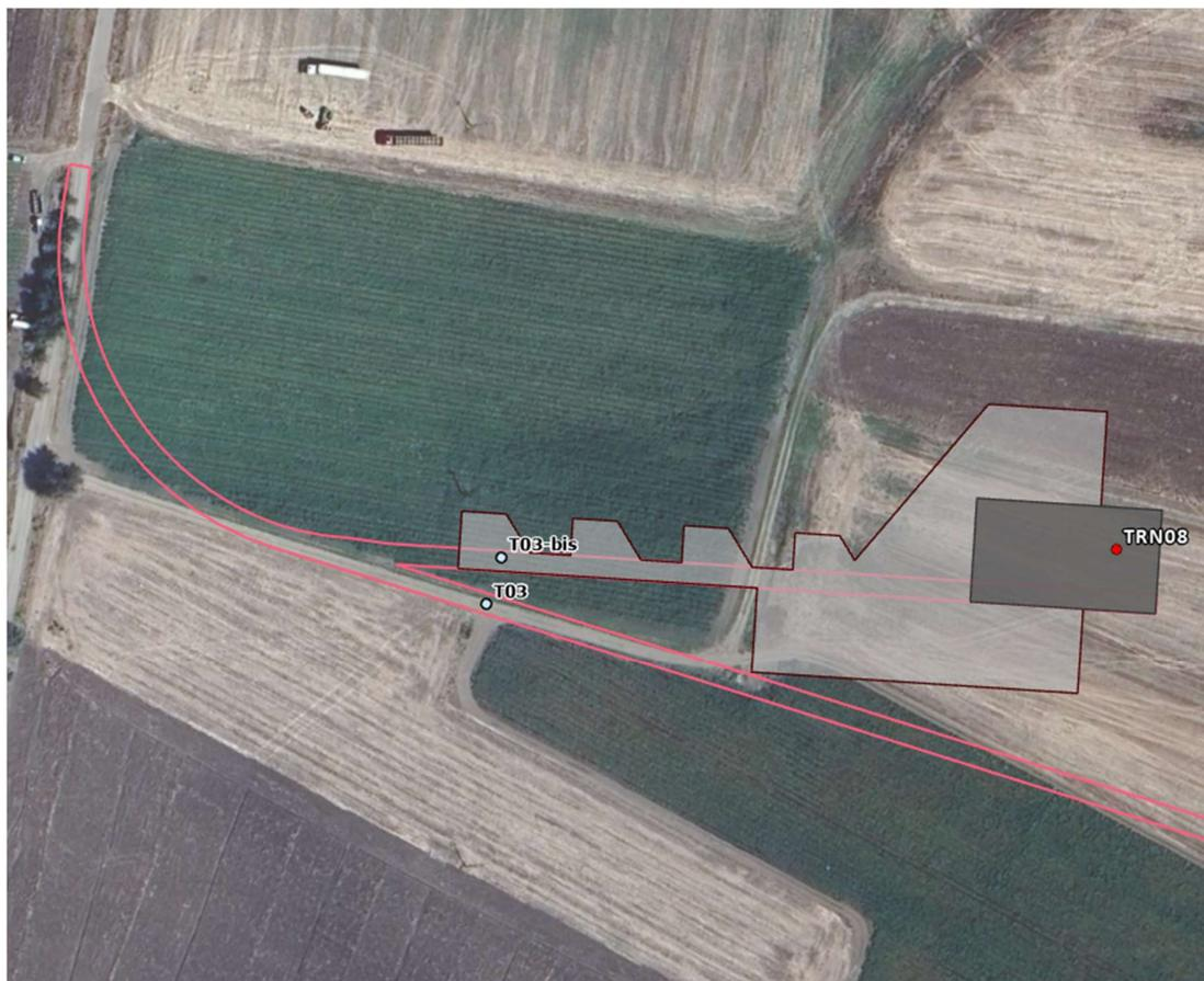
Figura 7-4: Interferenza T03 tra la viabilità di nuova realizzazione e un solco di drenaggio naturale.
