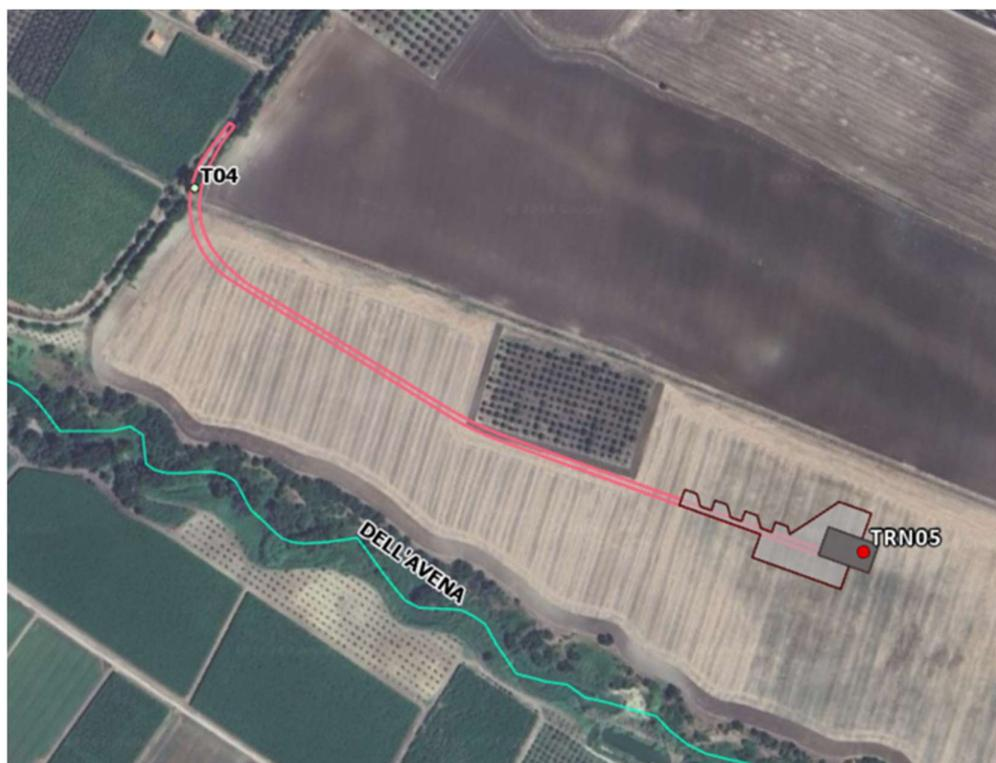
Figura 7-5: Interferenza T04 tra la viabilità di nuova realizzazione e un solco di drenaggio naturale.
