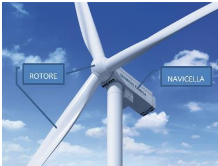
Figura 2.1: Rappresentazione di un aerogeneratore.
