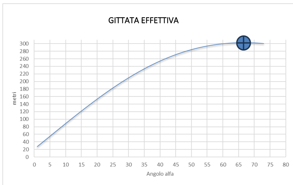
Figura 2.5: Calcolo Gittata Effettiva vs. angolo di distacco [°], si rimanda al paragrafo 3 per la definizione delle traiettorie.
