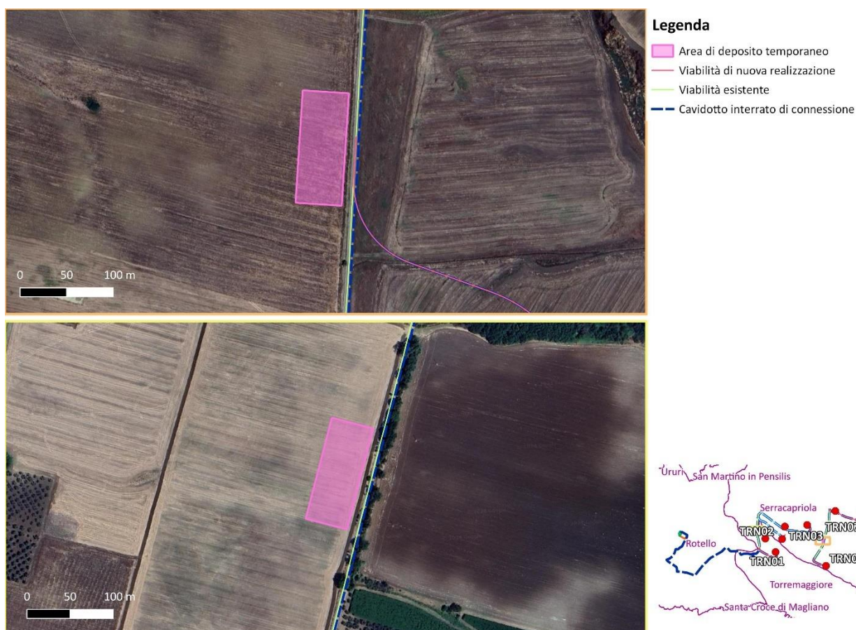
Figura 2.14: Localizzazione delle aree di deposito temporaneo per la fase di cantiere all'interno dell'impianto.
