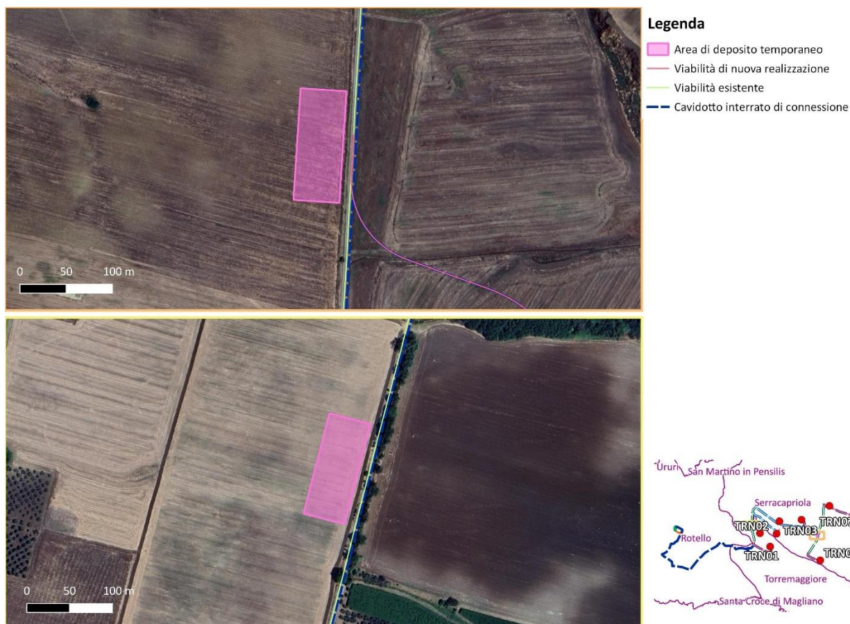
Figura 3.14: Localizzazione delle aree di deposito temporaneo per la fase di cantiere all'interno dell'impianto.
