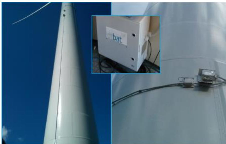
Figura 6.3: sensori del sistema DTBat® prodotti dalla società Liquen Consultoria Ambientale S.l.
