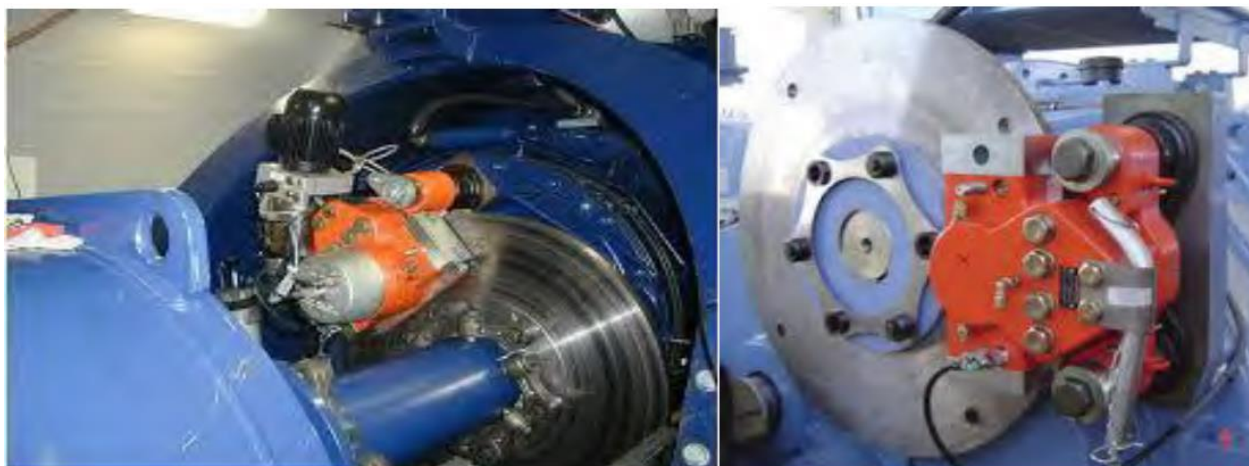
Figura 6.4: Sistemi di freno a disco sull'asse-rotore. Il sistema di controllo DTBird/Bat® invia un segnale di frenata del rotore che fa variare il passo delle pale, le pinze bloccano il movimento residuo della rotazione
