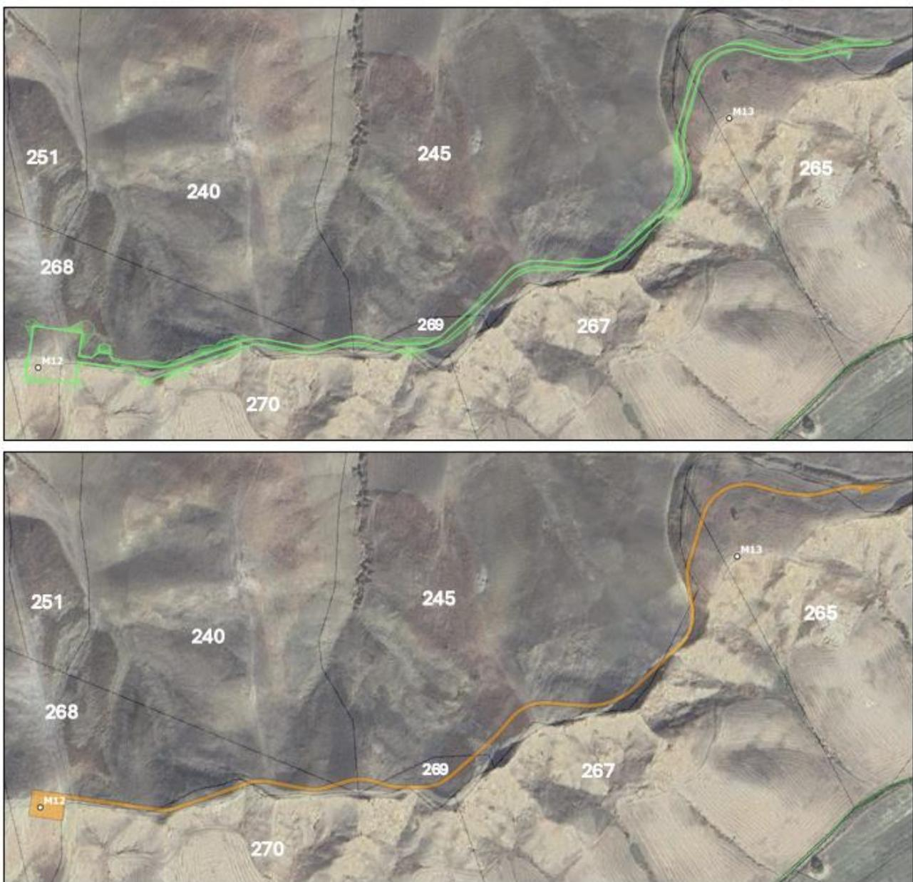
Figura 7-15 Rappresentazione grafica, su immagine satellitare e con catastale, della piazzola M12, e relativa via di accesso, in fase di cantiere (immagine sopra) e nella dimensione fisica, anche con la fondazione, (immagine sotto) (Fonte: Agenzia delle Entrate)
