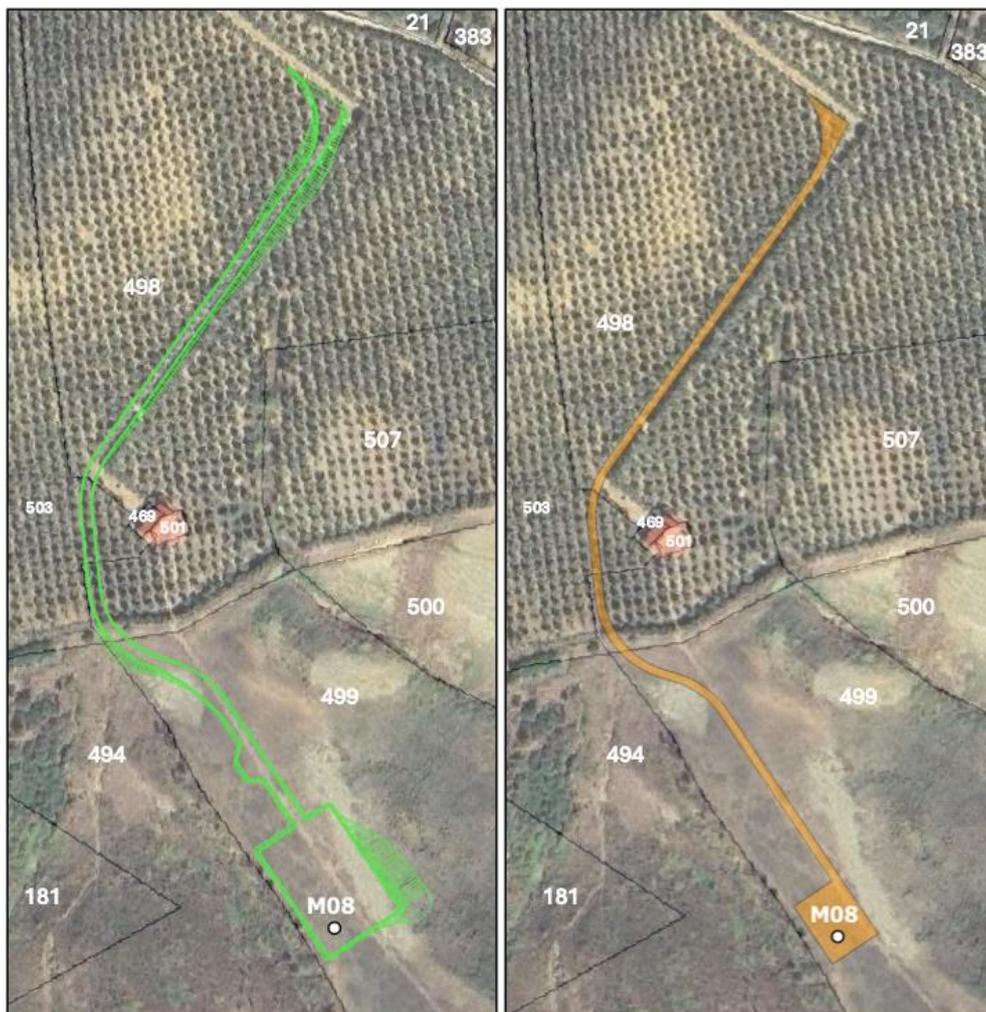
Figura 7-11 Rappresentazione grafica, su immagine satellitare e con catastale, della piazzola M08, e relativa via di accesso, in fase di cantiere (immagine a sinistra) e nella dimensione fisica, anche con la fondazione, (immagine a destra) (Fonte: Agenzia delle Entrate)
