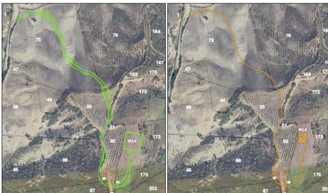
Figura 7-17 Rappresentazione grafica, su immagine satellitare e con catastale, della piazzola M14, e relativa via di accesso, in fase di cantiere (immagine a sinistra) e nella dimensione fisica, anche con la fondazione, (immagine a destra) (Fonte: Agenzia delle Entrate)
