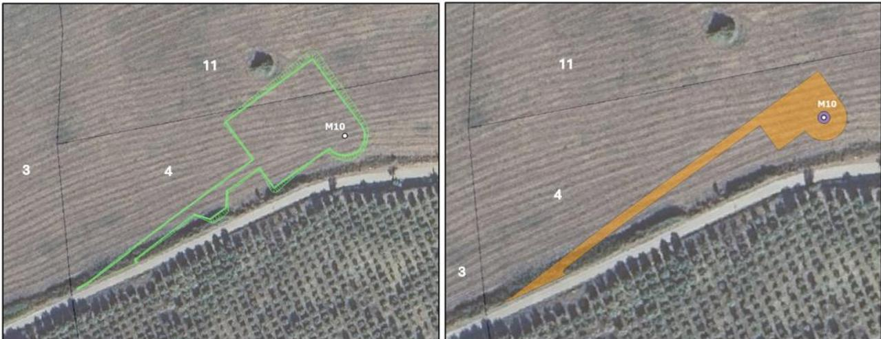
Figura 7-13 Rappresentazione grafica, su immagine satellitare e con catastale, della piazzola M10, e relativa via di accesso, in fase di cantiere (immagine a sinistra) e nella dimensione fisica, anche con la fondazione, (immagine a destra) (Fonte: Agenzia delle Entrate)
