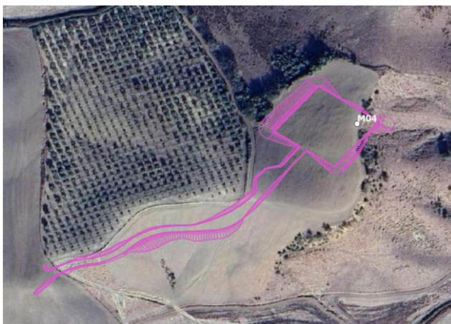
*Figura 2-32 Rappresentazione su immagine satellitare dell'impronta a terra della piazzola M04, e della relativa strada di accesso, nella fase costruttiva*
