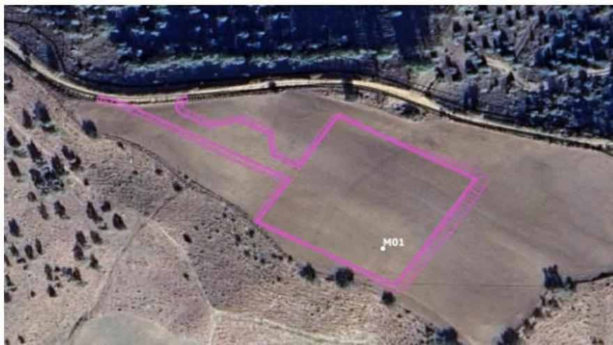
*Figura 2-29 Rappresentazione su immagine satellitare dell'impronta a terra della piazzola M01, e della relativa strada di accesso, nella fase costruttiva*
