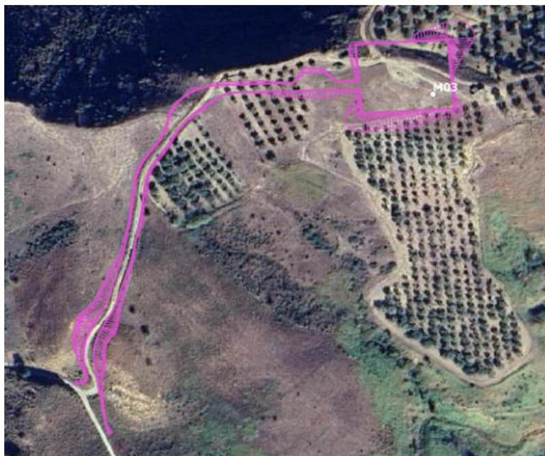
*Figura 2-31 Rappresentazione su immagine satellitare dell'impronta a terra della piazzola M03, e della relativa strada di accesso, nella fase costruttiva*
