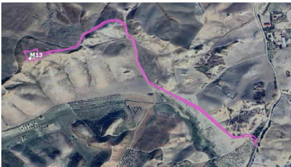
Figura 2-41 Rappresentazione su immagine satellitare dell'impronta a terra della piazzola M13, e della relativa strada di accesso, nella fase costruttiva
