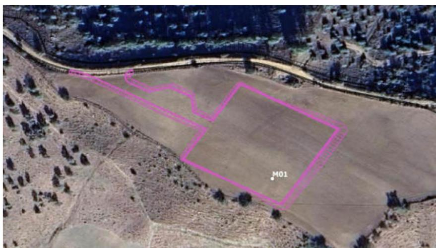
Figura 2-2 Rappresentazione su immagine satellitare dell'impronta a terra della piazzola M01, e della relativa strada di accesso, nella fase costruttiva
