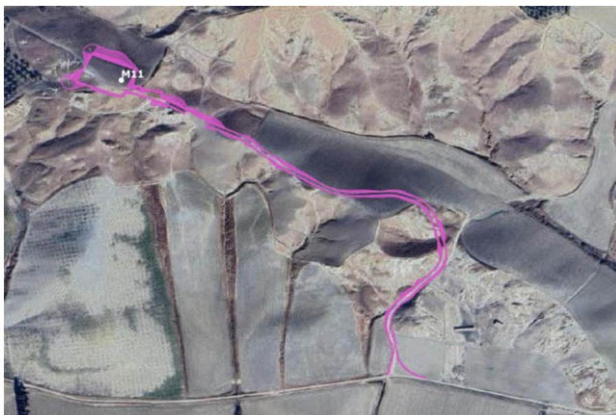
Figura 2-12 Rappresentazione su immagine satellitare dell'impronta a terra della piazzola M11, e della relativa strada di accesso, nella fase costruttiva
