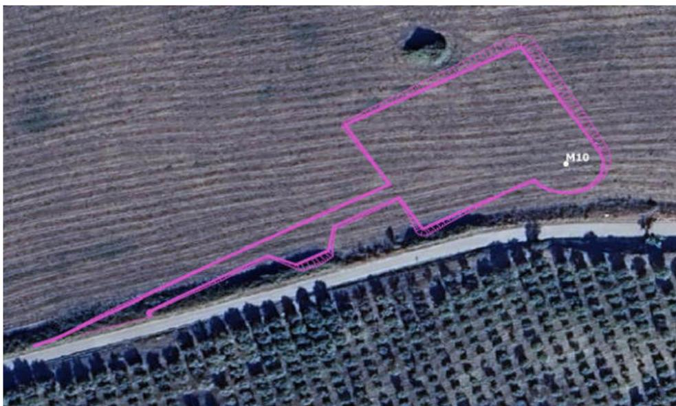
*Figura 2-38 Rappresentazione su immagine satellitare dell'impronta a terra della piazzola M10, e della relativa strada di accesso, nella fase costruttiva*
