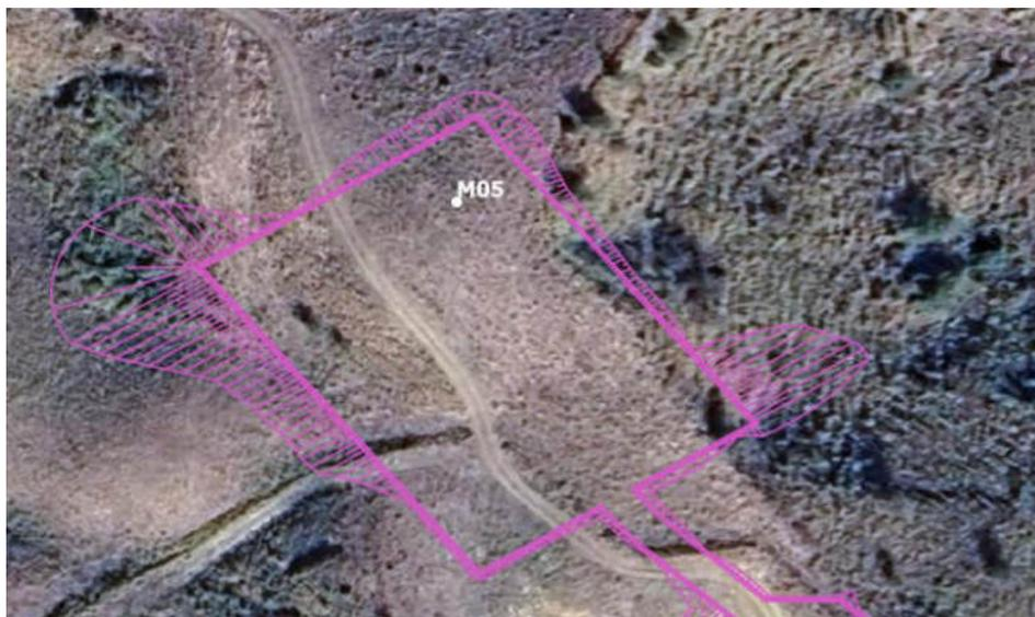
Figura 2-16 Rappresentazione schematica della piazzola dell'aerogeneratore M05 in fase di cantiere su immagini satellitari
