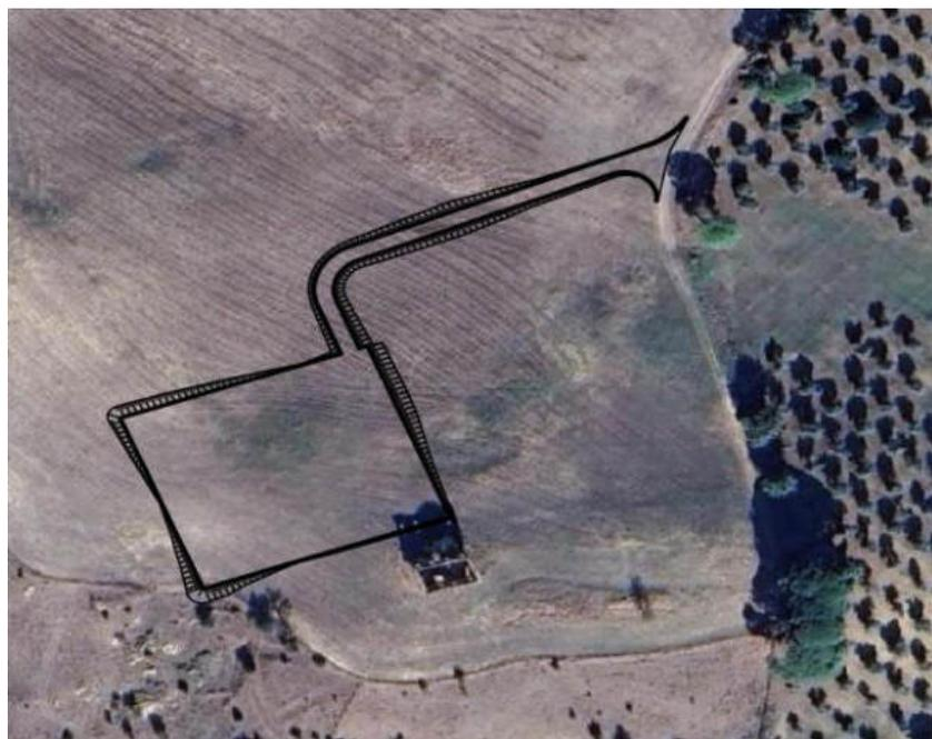
*Figura 2-84 Ubicazione della nuova Stazione Elettrica di Trasformazione (in nero) su immagini satellitari*
