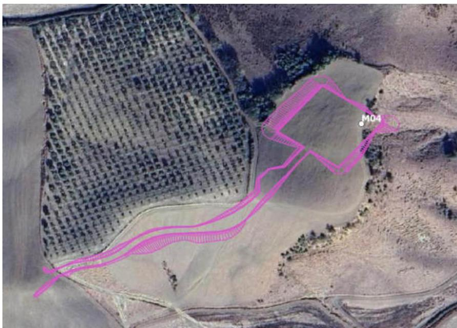
*Figura 2-5 Rappresentazione su immagine satellitare dell'impronta a terra della piazzola M04, e della relativa strada di accesso, nella fase costruttiva*
