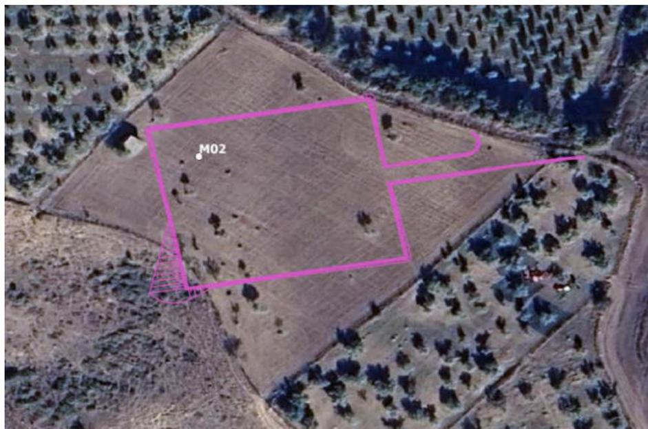
Figura 2-3 Rappresentazione su immagine satellitare dell'impronta a terra della piazzola M02, e della relativa strada di accesso, nella fase costruttiva
