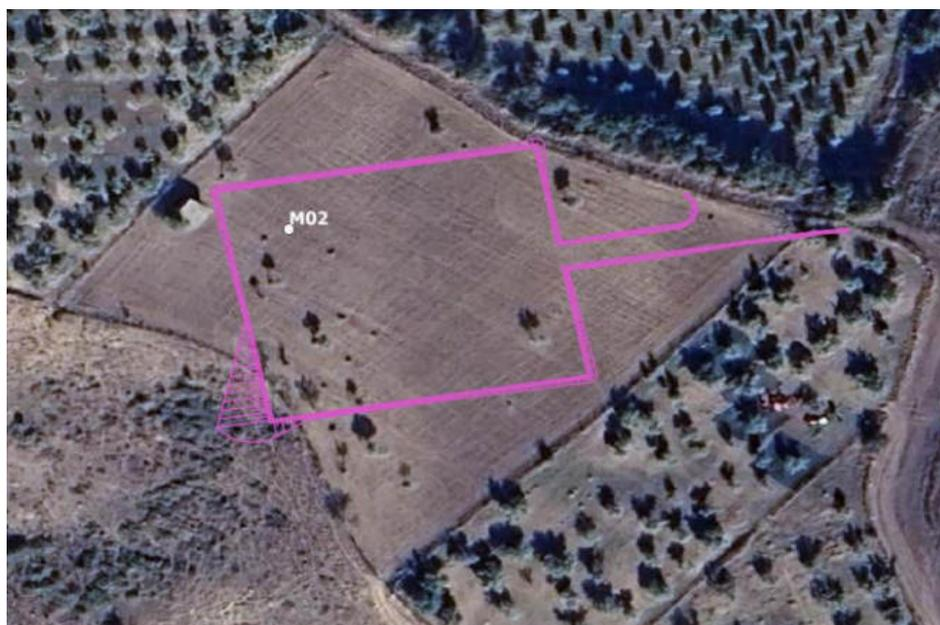
*Figura 2-30 Rappresentazione su immagine satellitare dell'impronta a terra della piazzola M02, e della relativa strada di accesso, nella fase costruttiva*
