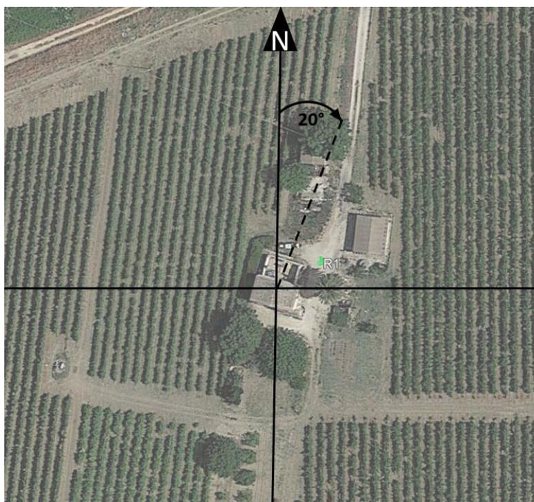
Figura 3-8 Esempio di identificazione dell'orientamento delle finestre dei ricettori
