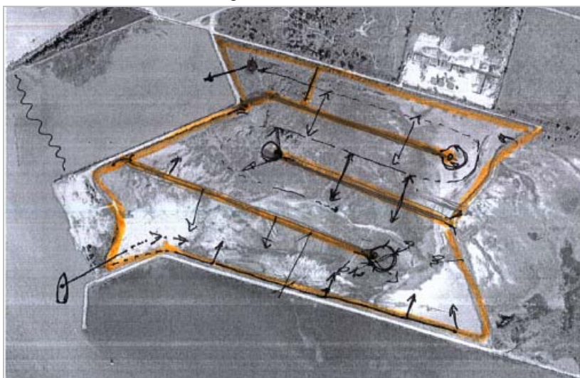
Figura 1- Preparazione Cassa di Colmata: sistema di drenaggio ed eventuali arginelli per allungare il percorso del sedimento
