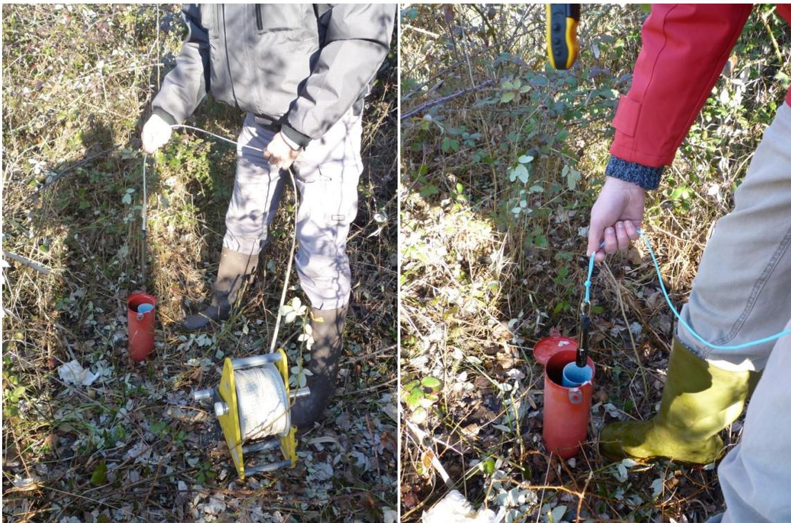
*Fig. 2.1-5 - Misurazione del livello della falda (sinistra) e log di pozzo con sonda CTD (destra)*
