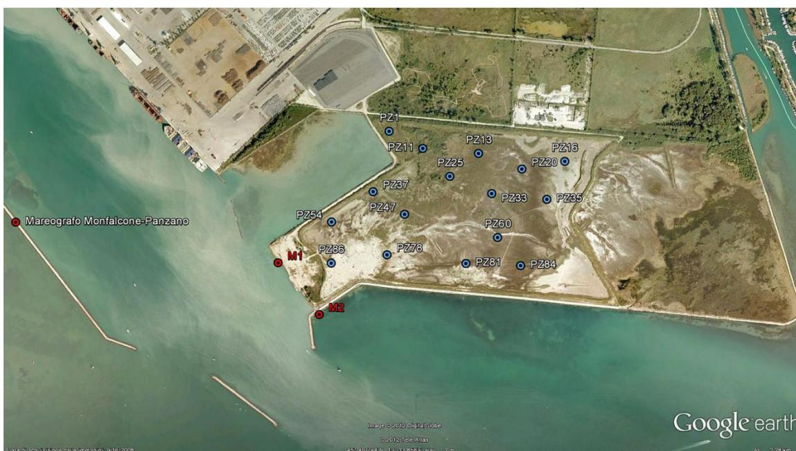
Fig. 2.1-1 - Ubicazione dei piezometri all'interno della Cassa di Colmata e posizione del mareografo di riferimento per il confronto tra le curve di marea e l'oscillazione della falda e dei parametri ad essa correlati. Sono, inoltre, indicati i punti di campionamento a mare (M1 ed M2)
