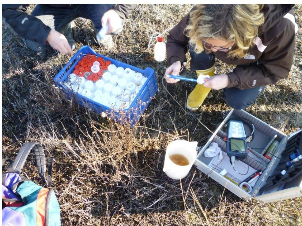
*Fig. 2.2-2 - Misura in campo dei parametri Eh, pH e conducibilità elettrica*
