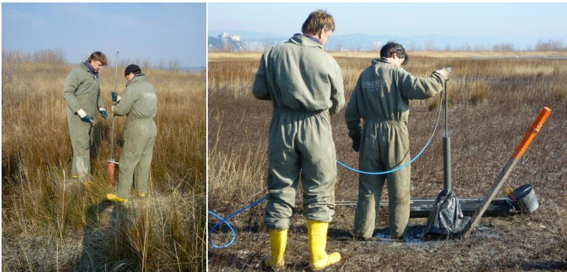
*Fig. 2.4-1 - Sviluppo dei piezometri: inserimento della tubazione metallica nel piezometro (sinistra) e fase d'insufflazione dell'area compressa (destra).*
