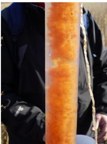
**Figura 4.5-1** - Flocculazione di ossidi-idrossidi di ferro nel bailer, in corrispondenza del livello salino del PZ33.
