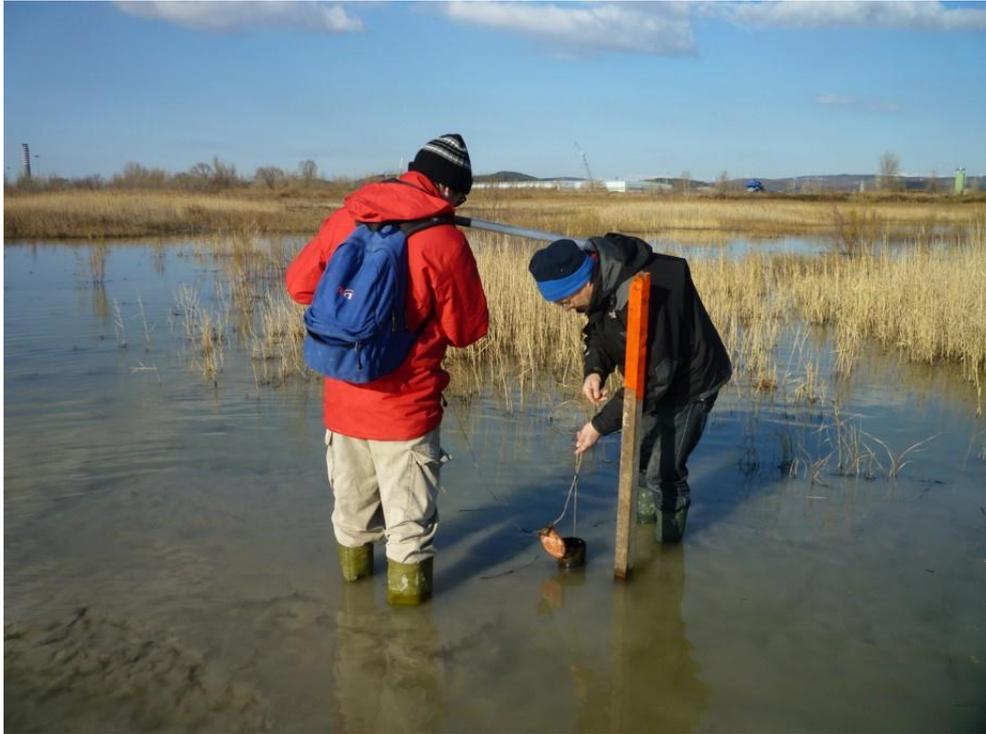
*Fig. 2.1-6 - Misurazione del livello della falda in uno dei piezometri sommersi, PZ35*
