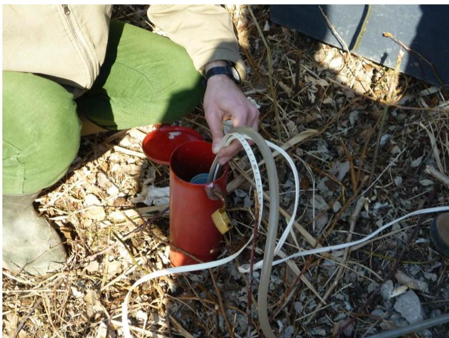
*Fig. 2.5-1 - Operazioni di spurgo del piezometro.*
