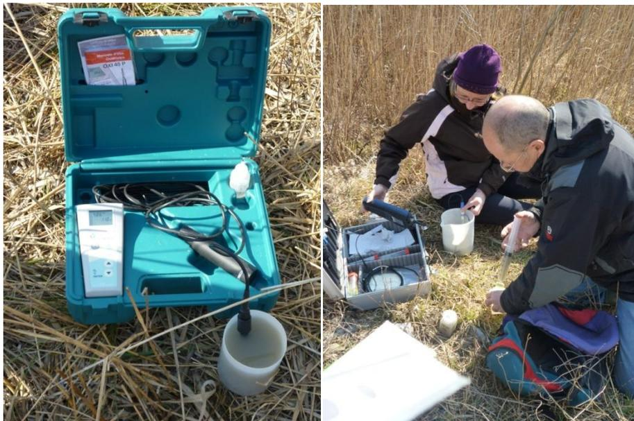
*Fig. 2.5-4 - Misurazione dell'ossigeno disciolto e filtrazione dei campioni d'acqua.*
