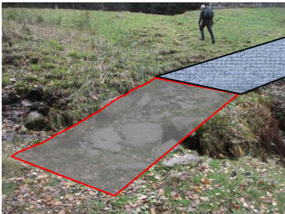
**FIGURA 84-UBICAZIONE LASTRA (GRIGIO) PER ATTRAVERSAMENTO CANALI DI DEFLUSSO E TAPPETO (TRAMA AZZURRA).**
