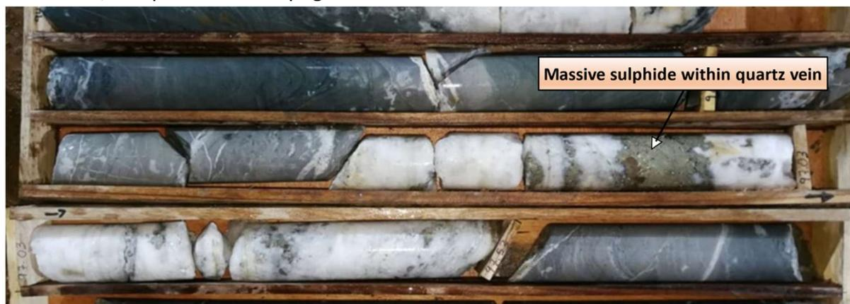
FIGURA 121-ESEMPIO DI FILONE DI QUARZO-SOLFURI IN CAROTAGGIO: FILONE DI 1,0 M CON SOLFURI MASSIVI (PIRITE-SFALERITE-GALENA) AL CENTRO CON VENUZZE DI QUARZO E CARBONATI A SPAZIATURA STRETTA, OLTRE A DUE PER CENTO DI PIRITE NEL CONTATTO DI TETTO DI UN GIACIMENTO.
