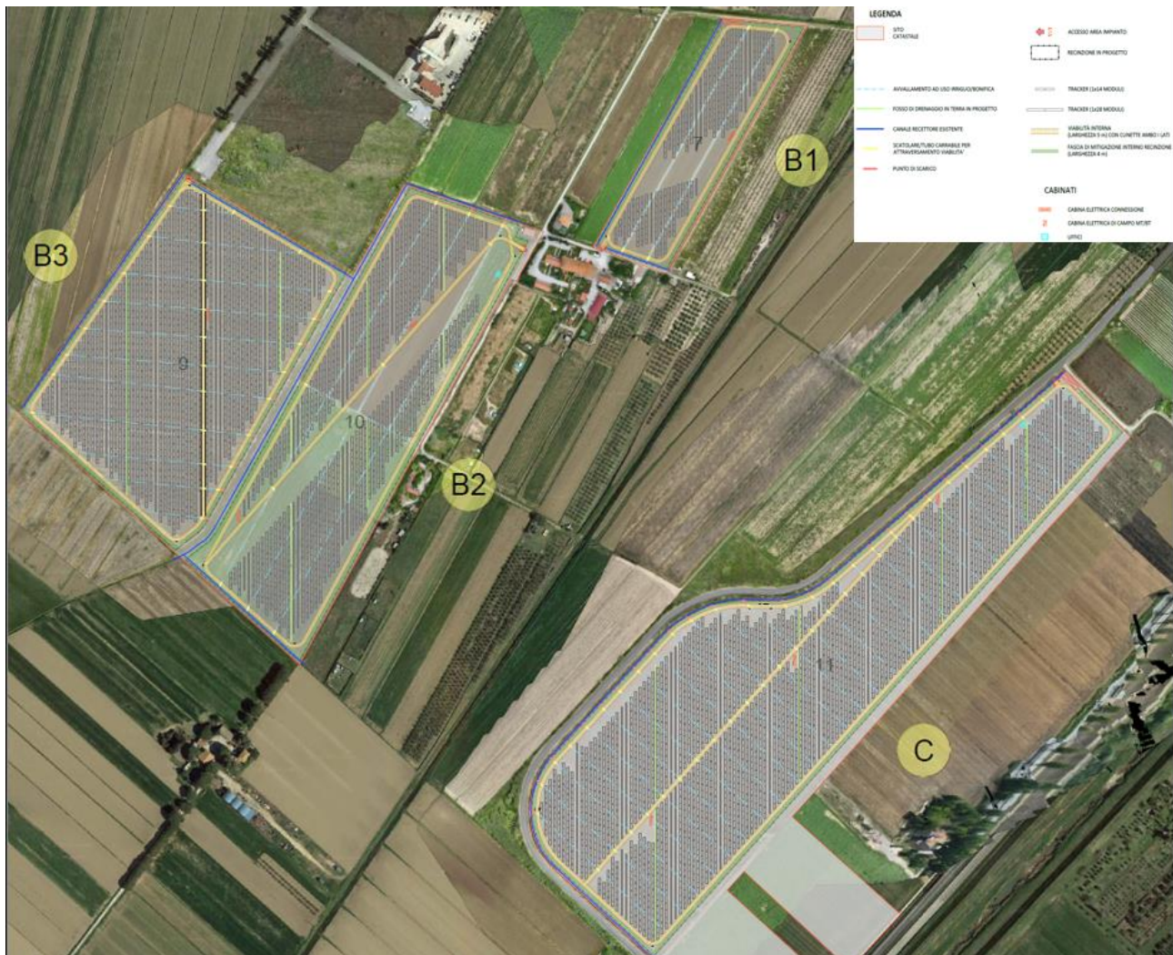
Figura 5-5: Campi B e C – Planimetria opere di regimentazione delle acque (Fonte: CoD21_FV_BCD_00094_Planimetria opere di regimazione delle acque_rev00b)
