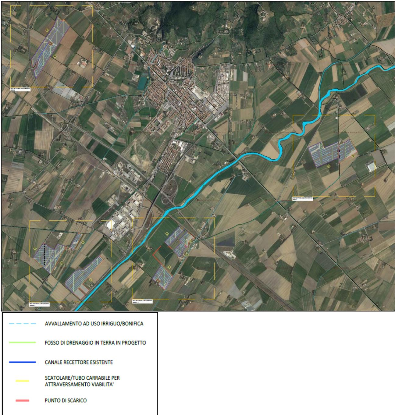
*Figura 6.12: Planimetria delle opere di regimentazione delle acque*
