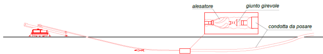
Figura 1-25: Fiancheggiamento con tecnica TOC NO DIG su banchina con giunti di ripresa
