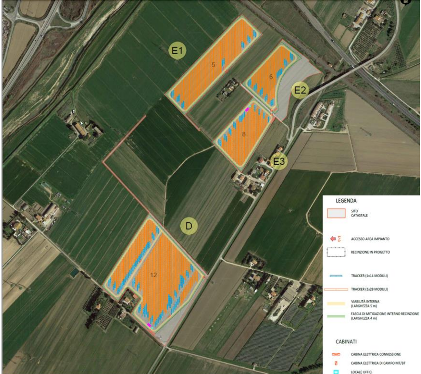
Figura 1-13 Layout impianto Campo D,E
