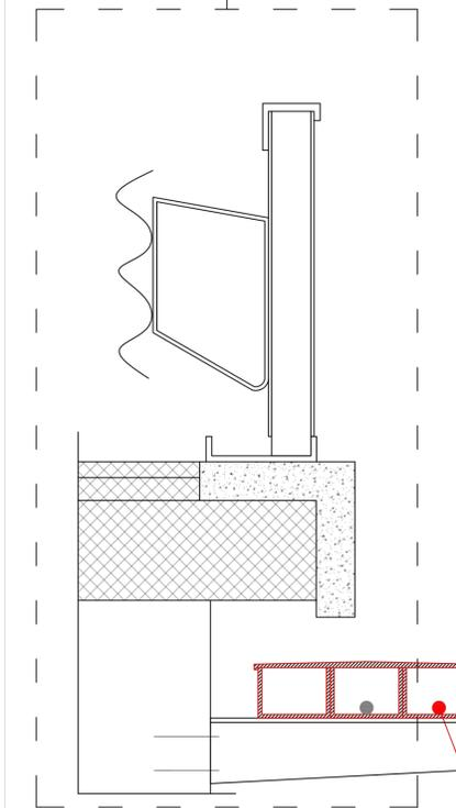
CAVIDOTTO DI PROGETTO STAFFATO al PONTE
