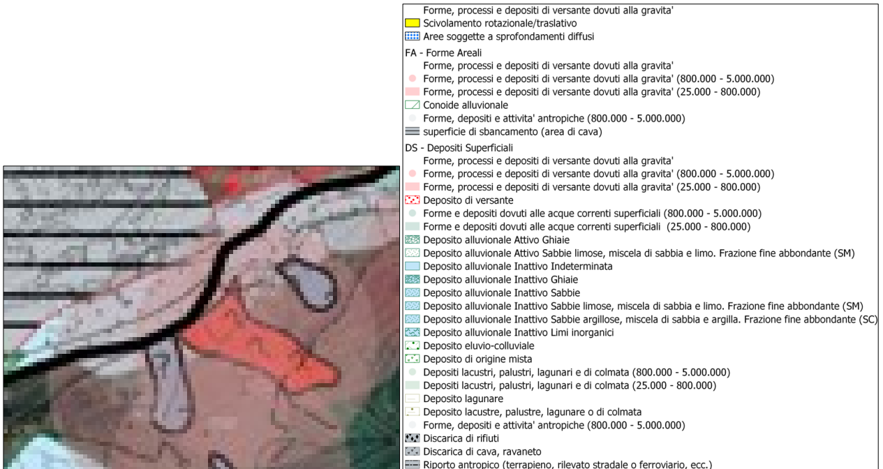
Figura 2-4: fuori scala della Carta Geomorfologica in calce al presente elaborato. Nel riquadro in giallo, l'ingrandimento in figura sotto. In tratto nero spesso il tracciato della connessione il quale intercetta, in maniera marginale, nella parte bassa del versante, i due corpi di frana da scorrimento: quello rosso è attivo, quello in grigio è inattivo.
