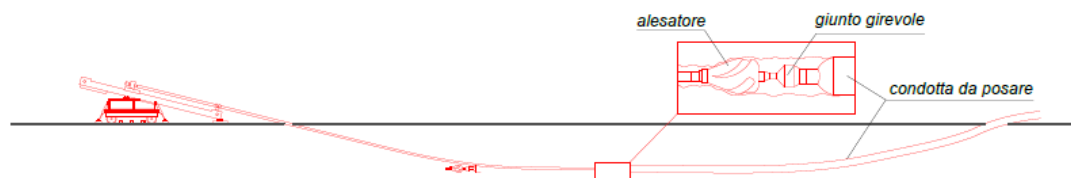
Figura 1-13: Fiancheggiamento con tecnica TOC NO DIG su banchina con giunti di ripresa
