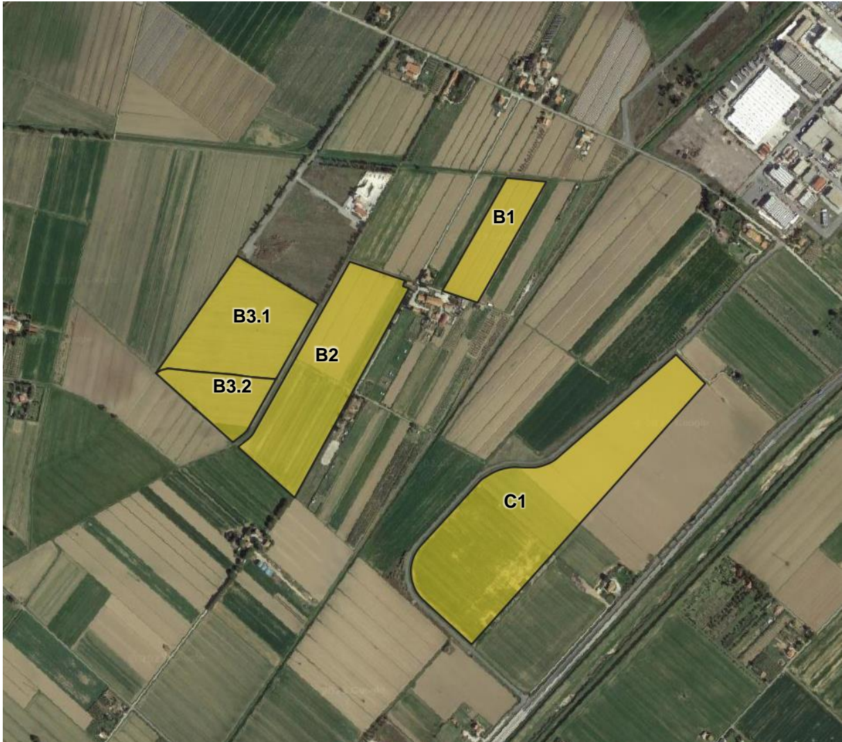
Figura 5.4: Delimitazione bacini scolanti (giallo) e relativa codifica delle sezioni B1, B2, B3, C1, C2
