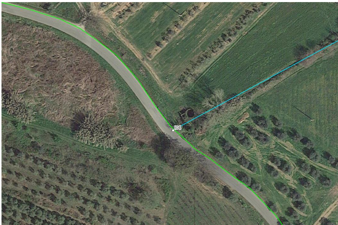
Figura 6.17: Ubicazione su ortofoto dell'interferenza I04, in verde il tracciato del cavidotto di connessione, in azzurro il reticolo idrico
