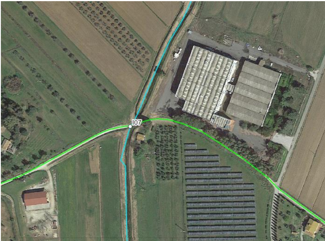
Figura 6.23: Ubicazione su ortofoto dell'interferenza I07, in verde il tracciato del cavidotto di connessione, in azzurro il reticolo idrico
