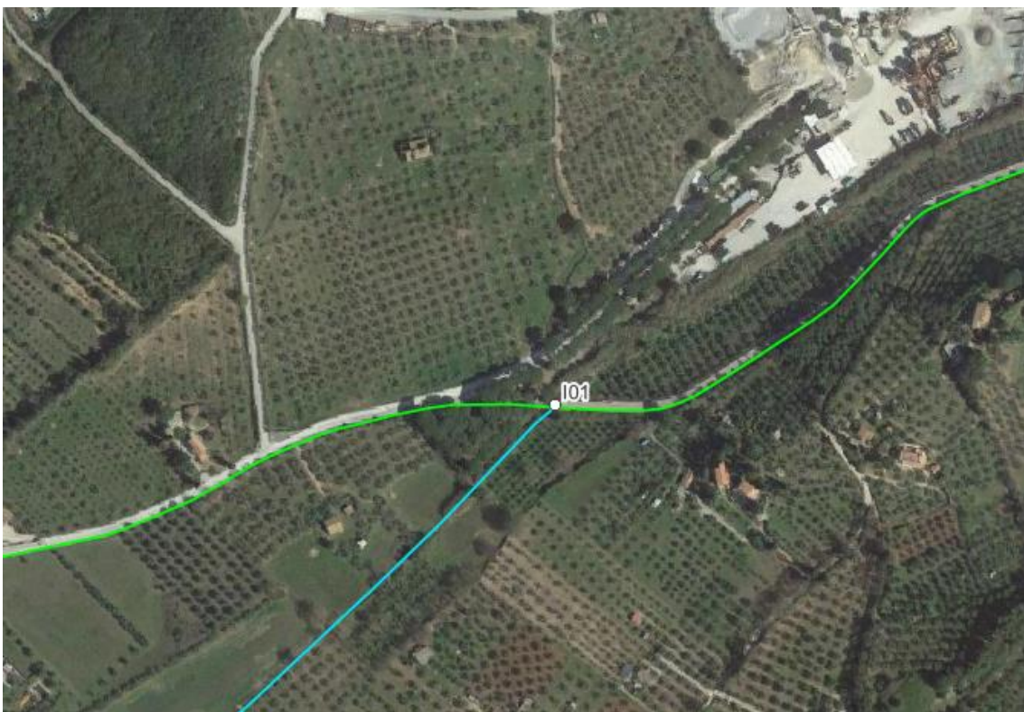
Figura 6.11: Ubicazione su ortofoto dell'interferenza I01, in verde il tracciato del cavidotto di connessione, in azzurro il reticolo idrico
