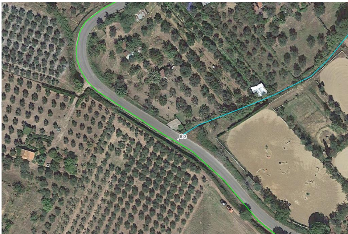
Figura 6.15: Ubicazione su ortofoto dell’interferenza I03, in verde il tracciato del cavidotto di connessione, in azzurro il reticolo idrico
