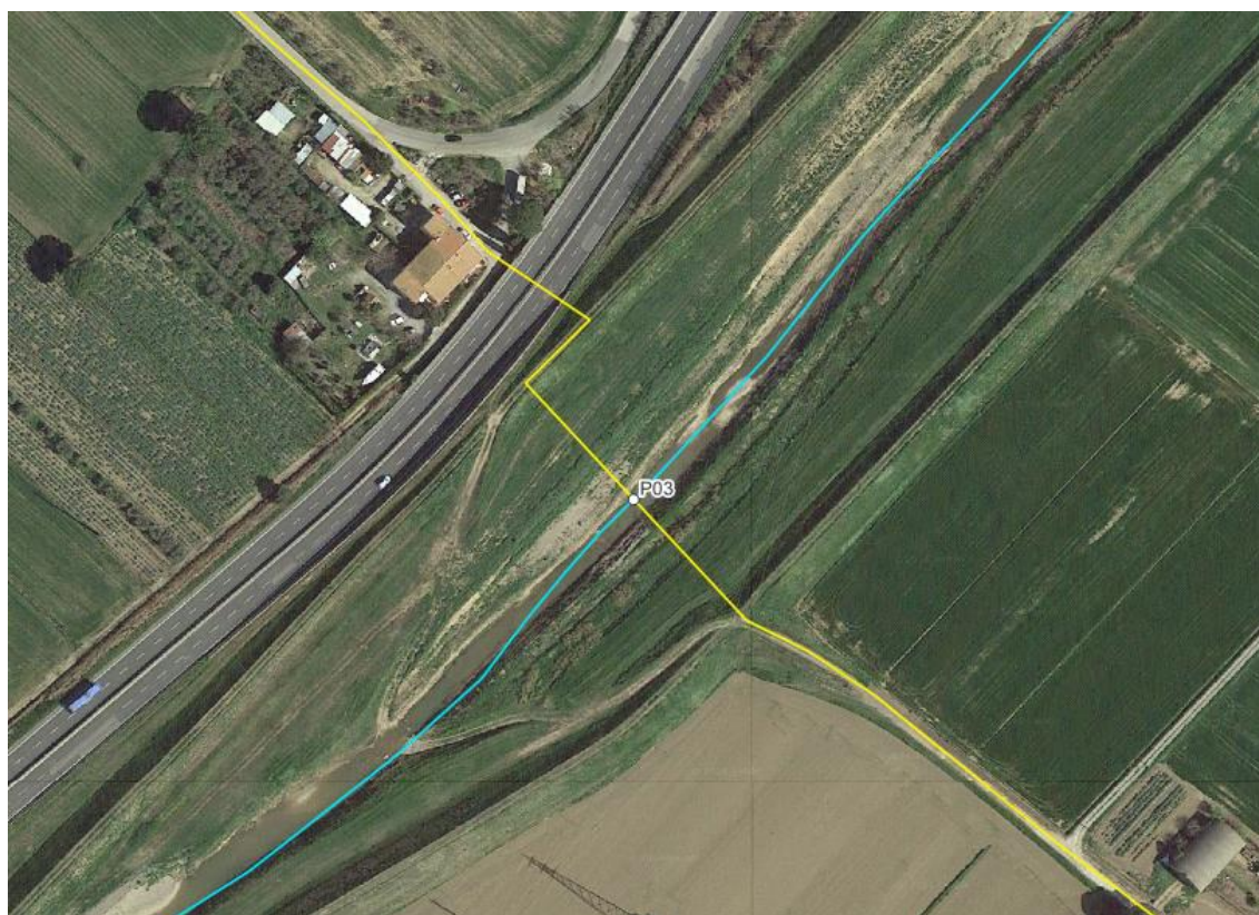
Figura 6.41: Ubicazione su ortofoto dell'interferenza P03, in giallo il tracciato del cavidotto di interconnessione, in azzurro il reticolo idrico
