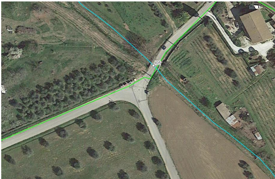
Figura 6.19: Ubicazione su ortofoto dell'interferenza I05, in verde il tracciato del cavidotto di connessione, in azzurro il reticolo idrico
