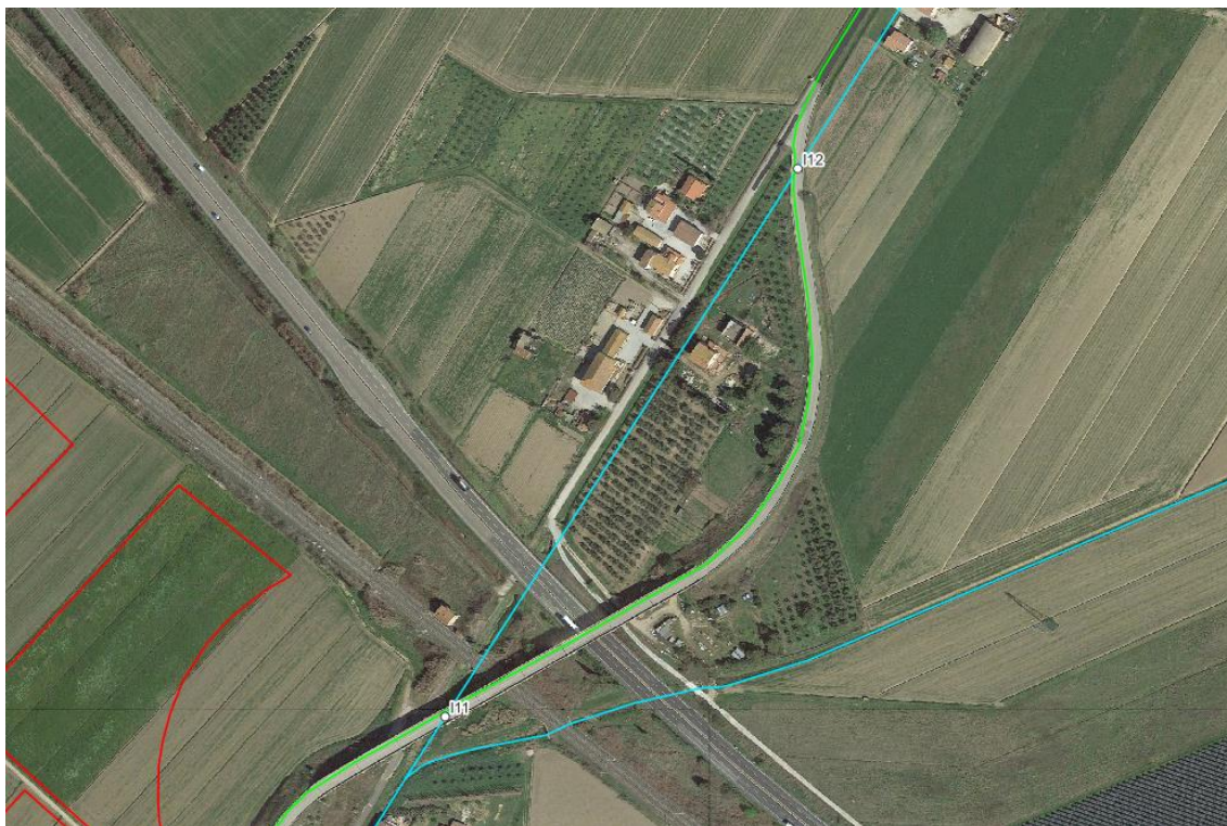
Figura 6.31: Ubicazione su ortofoto dell'interferenza I11, in verde il tracciato del cavidotto di connessione, in azzurro il reticolo idrico
