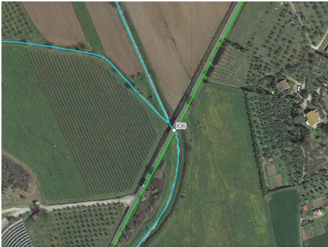
Figura 6.21: Ubicazione su ortofoto dell'interferenza I06, in verde il tracciato del cavidotto di connessione, in azzurro il reticolo idrico
