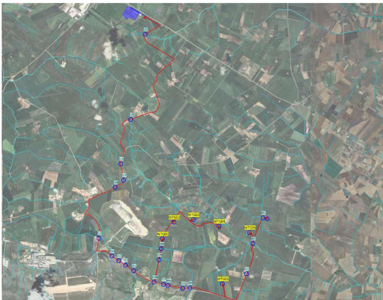
**Figura 3 - Individuazione planimetrica delle interferenze idrauliche rispetto alle opere di progetto su ortofoto**
