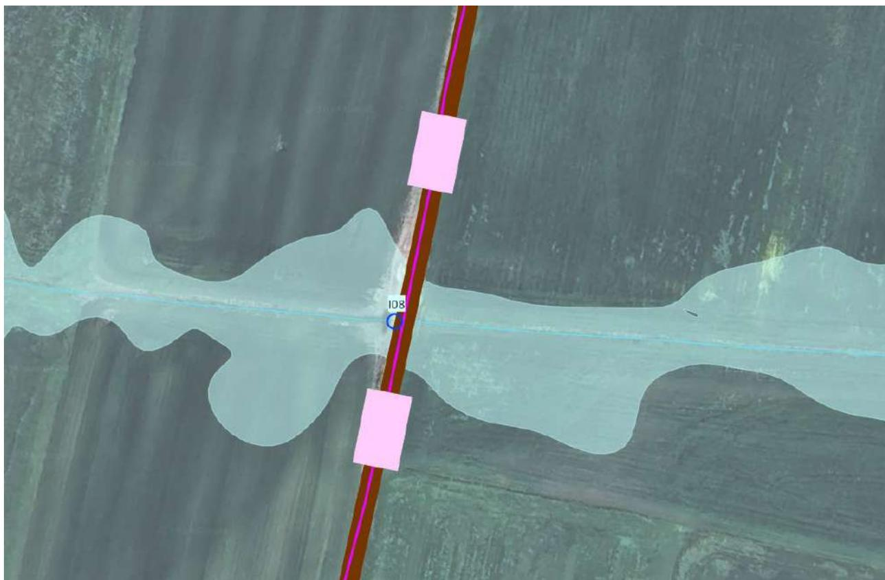
**Figura 21 - Rappresentazione della TOC e delle aree di cantiere in corrispondenza della I08**
