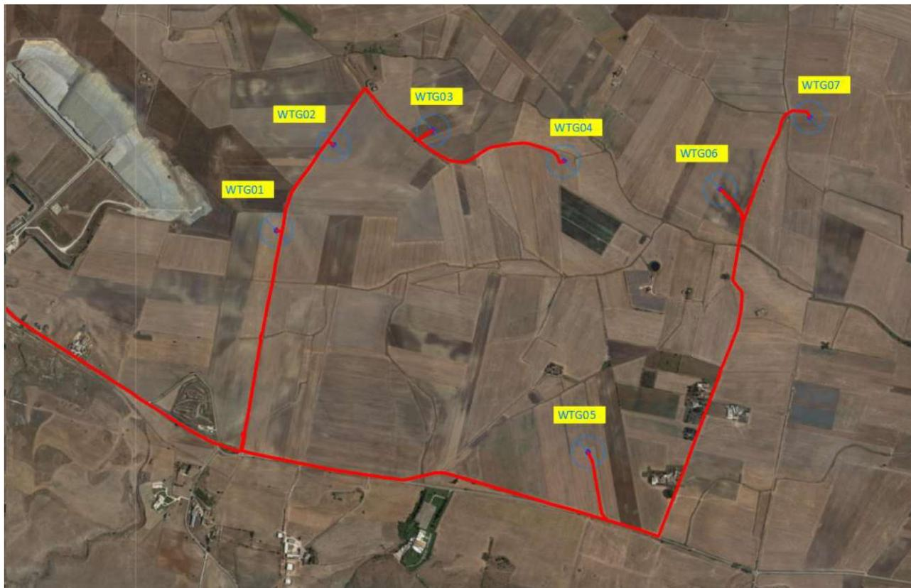
*Figura 16 - Schematizzazione dell'area di cantiere con dettaglio delle turbine di progetto, delle strade interne al cantiere e dell'area temporanea di stoccaggio e movimentazione.*
