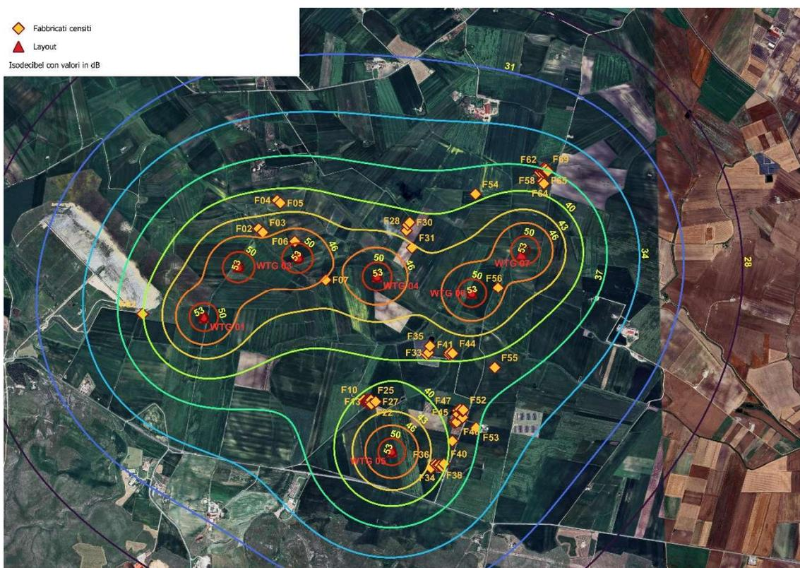
**Figura 11 - Inquadramento su ortofoto del Layout di progetto, del sistema edificato censito e le isodocibel restituite dal software.**
