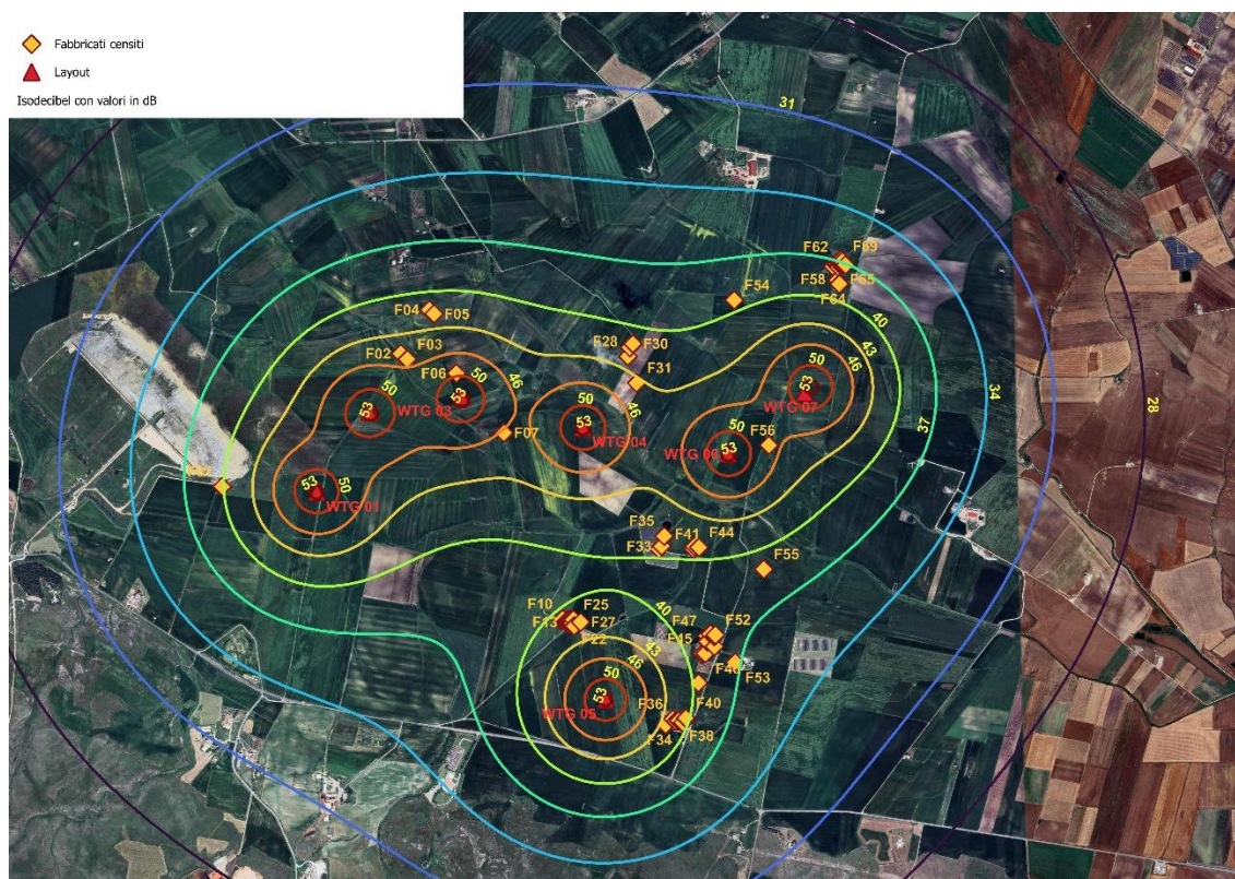
Figura 27 – Inquadramento su ortofoto del layout di progetto, del sistema edificato censito e le isodocibel restituite dal software
