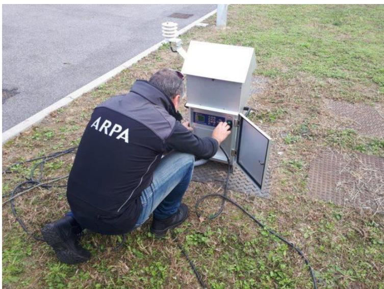
*Figura 3 - Esempio di campionario per il monitoraggio della qualità dell'aria (Fonte: Arpa Lombardia)*
